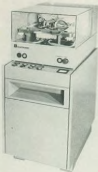
Bild 1: Die Trennläppmaschine dient zur Her-stellung von Halbleiterwürfeln aus Kristall-scheiben mit epitaktisch oder ähnlich vor-behandelten Oberflächen. Die Halbleiter-scheiben selbst werden mit Hilfe des Peltier-effekts angefroren und festgehalten (oben)
