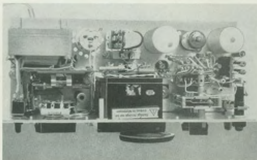
Bild 5: Ansicht des Chassis von hinten, in der hinteren Reihe sind von links nach rechts zu erkennen C4/C7, ECC 81, C8, Relais A, 150-V-Stabilisator (hier keine handelsübliche Ausführung), Netztransformator; dahinter Schalter S1 (hier „Fobana“-Mehrstellenschalter), Meßinstrument und Lötösenplatte für Netzteil
