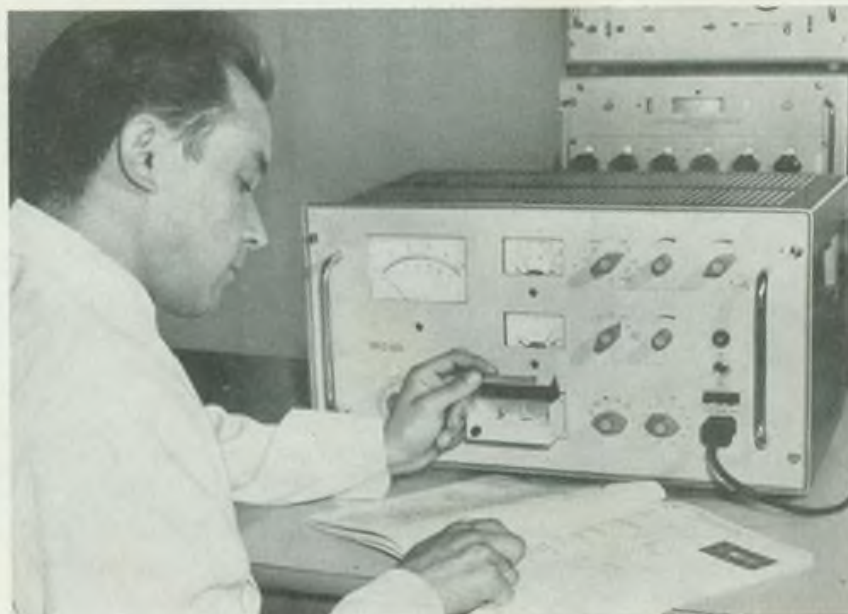
Bild 2: Das Rauschfaktormeßgerät „RFG 103“ des VEB Meßelektronik Dresden dient zur Bestimmung des Rauschfaktors von aktiven und passiven Bauelementen im Frequenzbereich von 500 Hz bis 1,5 kHz. Direkt gemessen werden können Rauschfaktoren von Transistoren (bipolar und FET) sowie von ein- und mehrstufigen Hybrid- und Dünnschichtschaltungen. Die Messung bei passiven Bauelementen erfolgt indirekt.
