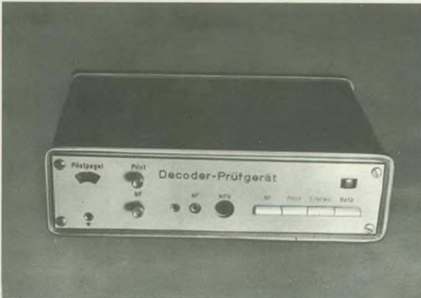
Bild 5: Ansicht des beschriebenen Prüfgerätes zum Überprüfen von Stereodecodern
