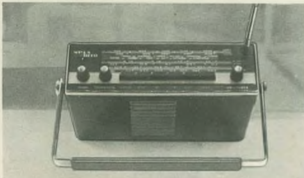
Universell verwendbar ist der Transistor-Koffersuper „Ural-Auto“ mit den Wellenbereichen UKW-LW-MW-3 \times KW . . .
