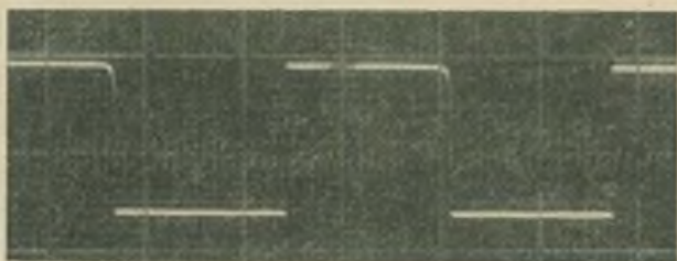
Bild 8: wie Bild 6, aber C_1 = 0,1 \text{ uF} , Y = 2 \text{ V/cm}
