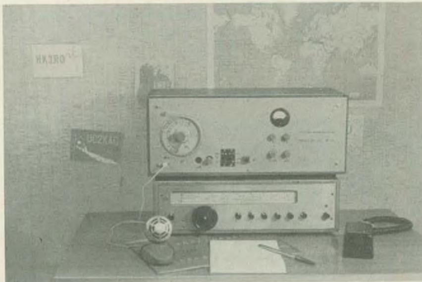
**Bild 1:** Stationsfoto der transistorsierten Sende-Empfangsstation DM 2 CEK, oben der Transistor-SSB-Sender, darunter der KW-Transistorempfänger für die KW-Amateurbänder
