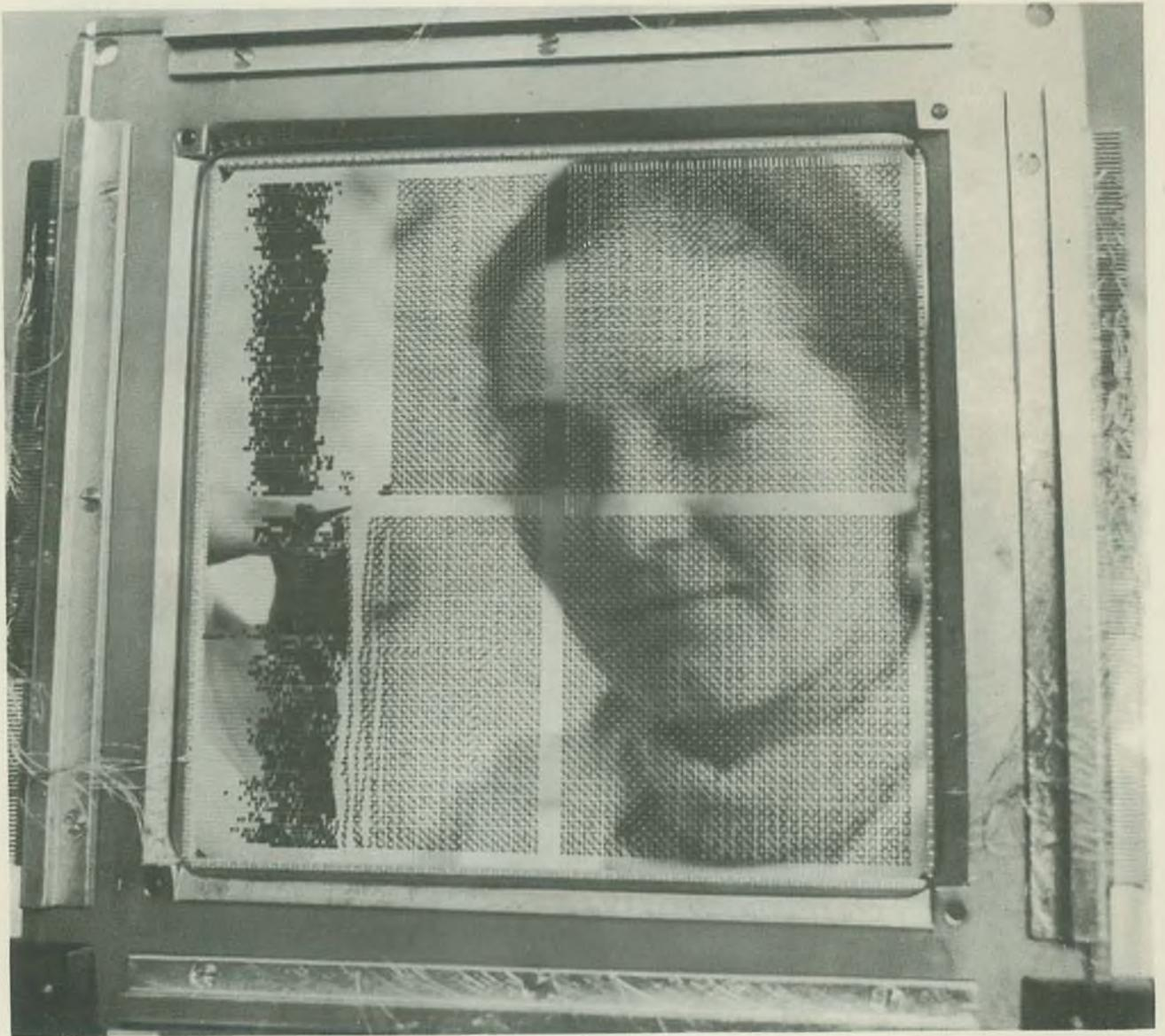
**Digitalrechner der ODRA-Reihe aus dem Werk für elektronische Ausrüstungen ELWRO in Wroclaw arbeiten bereits seit einigen Jahren in den sozialistischen Ländern. Unser Bild zeigt die Montage des magnetischen Speichers für einen Digitalrechner „ODRA 1304“**
