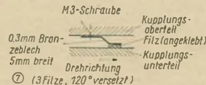
Bild 7: Die Konstruktion der Schwungmasse
