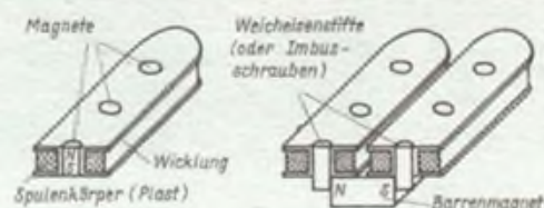
Bild 1: Schnitt durch einen Einzelspulentonabnehmer
