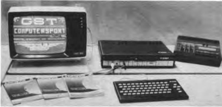
Ein Arbeitsplatz im Computersport der GST ist mit den gezeigten Geräten ausgerüstet – Kleincomputer KC 85/3, S/W-Fernsehgerät und Kassettenbandgerät
