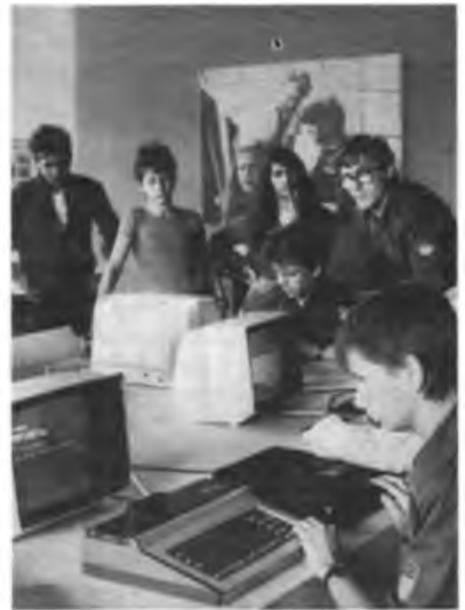
Der Kleincomputer KC 85/1 bzw. KC 87 des VEB Robotron-Meßelektronik „Otto Schön“ Dresden ist als Kompaktgerät ausgeführt. In das auch die Tastatur integriert ist
