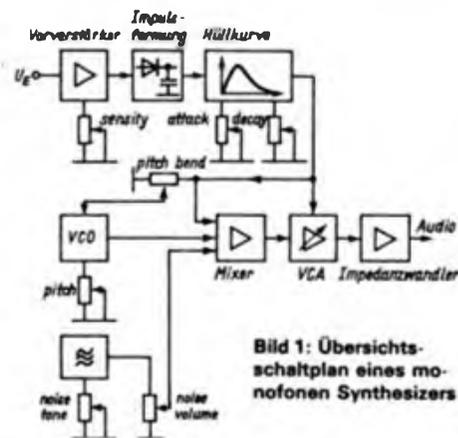
Bild 1: Übersichtsschaltplan eines monofonen Synthesizers
