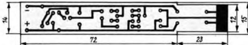
Bild 2: Leitungsführung der Platine für den CMOS-Logikprüfstift
