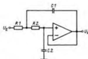
Bild 3: Tiefpaß 2. Ordnung mit Einfachmitkopplung ( $v_o = 1$ ;  $R_1 = R_2$ ;  $C_1 = C_2$ )
