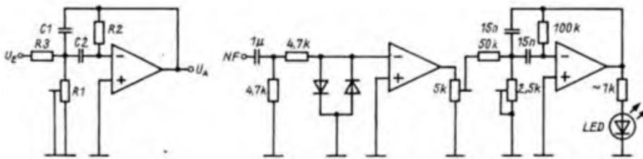
Bild 10: Normalform eines aktiven Bandpasses ( $C_1 = C_2$ ;  $R_2 \geq 10 R_1$ )
