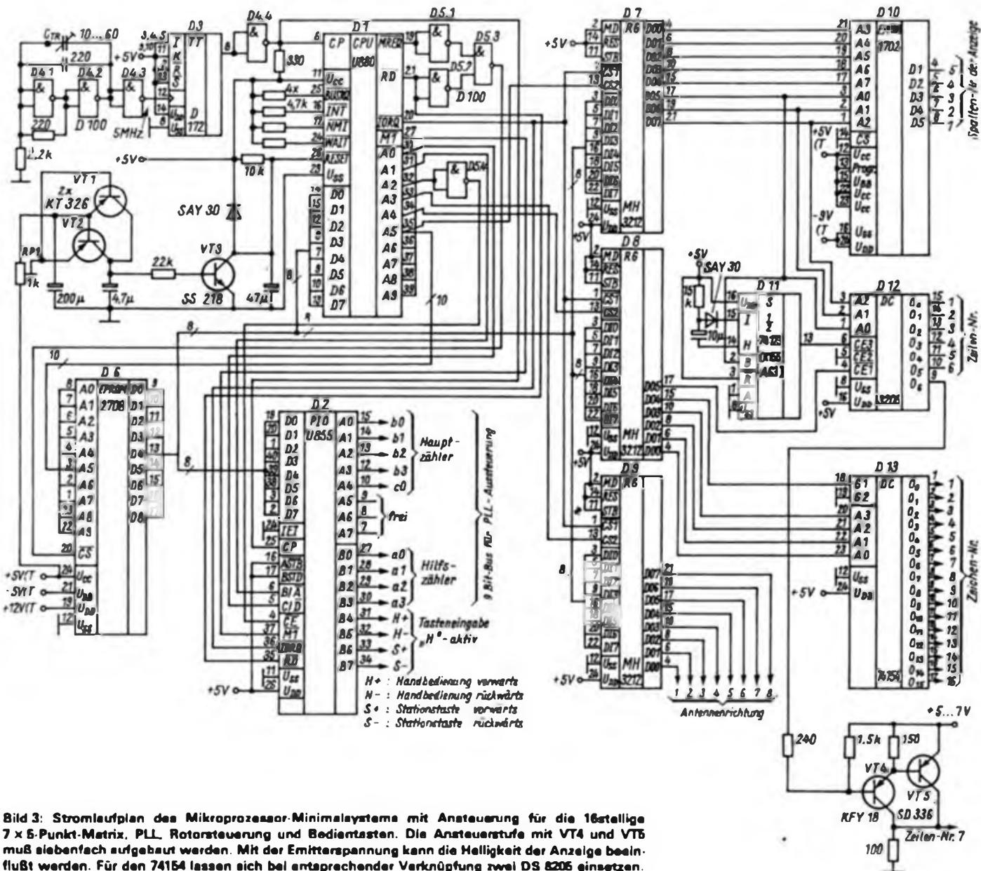
Bild 3: Stromlaufplan des Mikroprozessor-Minimalsystems mit Ansteuerung für die 16stellige 7 x 5-Punkt-Matrix. PLL, Rotorsteuerung und Bedientasten. Die Ansteuerstufe mit VT4 und VT5 muß siebenfach aufgebaut werden. Mit der Emitterspannung kann die Helligkeit der Anzeige beeinflusst werden. Für den 74154 lassen sich bei entsprechender Verknüpfung zwei DS 8205 einsetzen.
