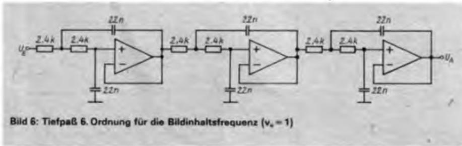
Bild 6: Tiefpaß 6. Ordnung für die Bildinhaltsfrequenz ( $v_n = 1$ )
