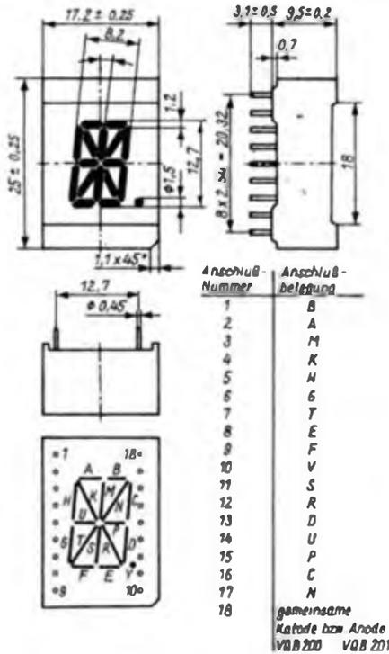
Bild 7: Maßangaben zu den Lichtemitteranzeigen VQB 200 und VQB 201
