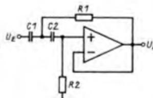
Bild 9: Hochpaß 2. Ordnung mit Einfachmitkopplung ( $v_n = 1$ ;  $R_1 = R_2$ ;  $C_1 = C_2$ )
