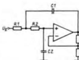
Bild 2: Tiefpaß 2. Ordnung mit Einfachmitkopplung ( $R_1 = R_2$ ;  $C_1 = C_2$ )
