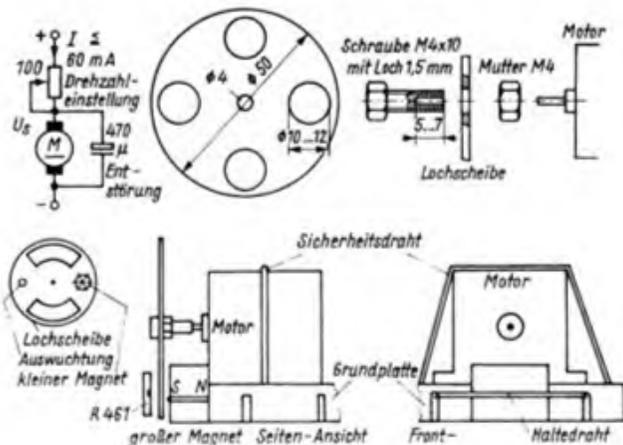
Bild 6.7: Drehzahl-einstellung und Realisierung von einem Impuls je Umdrehung (links o. und u.)
