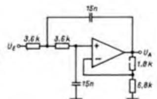
Bild 5: Besselfilter 2. Ordnung für den sendeseitigen NF-Kanal
