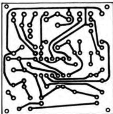
Bild 3: Leitungsführung der Platine für die elektronische Taste
