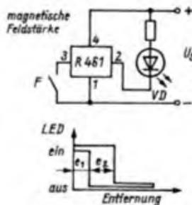
Bild 6.5/6.6: Prüf- und Testschaltung für die Hall-IS B(R) 461 G (oben) und Darstellung der Schaltpunkte einer Hall-IS B(R) 461 G (unten)
