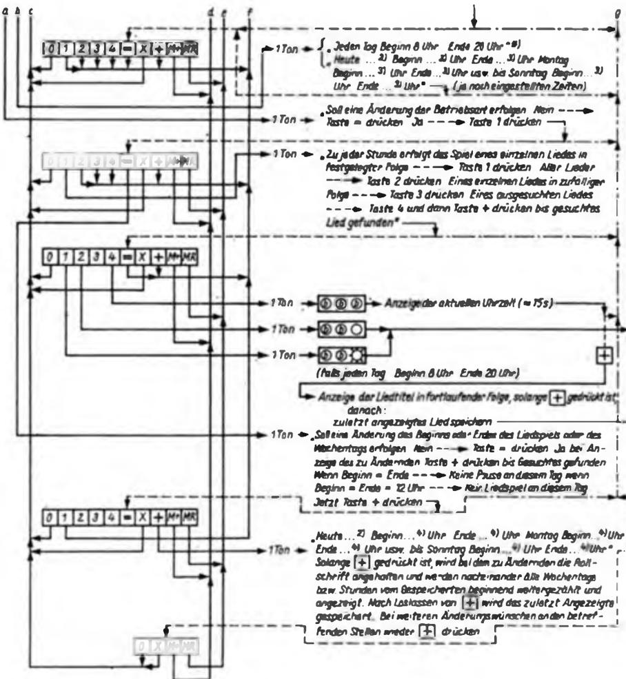
Bild 9: Ablaufschema für das Menüprogramm des mehrstimmigen Liedspiels mit Digitaluhr, Teil 1 - linke Seite, Teil 2 - oben
