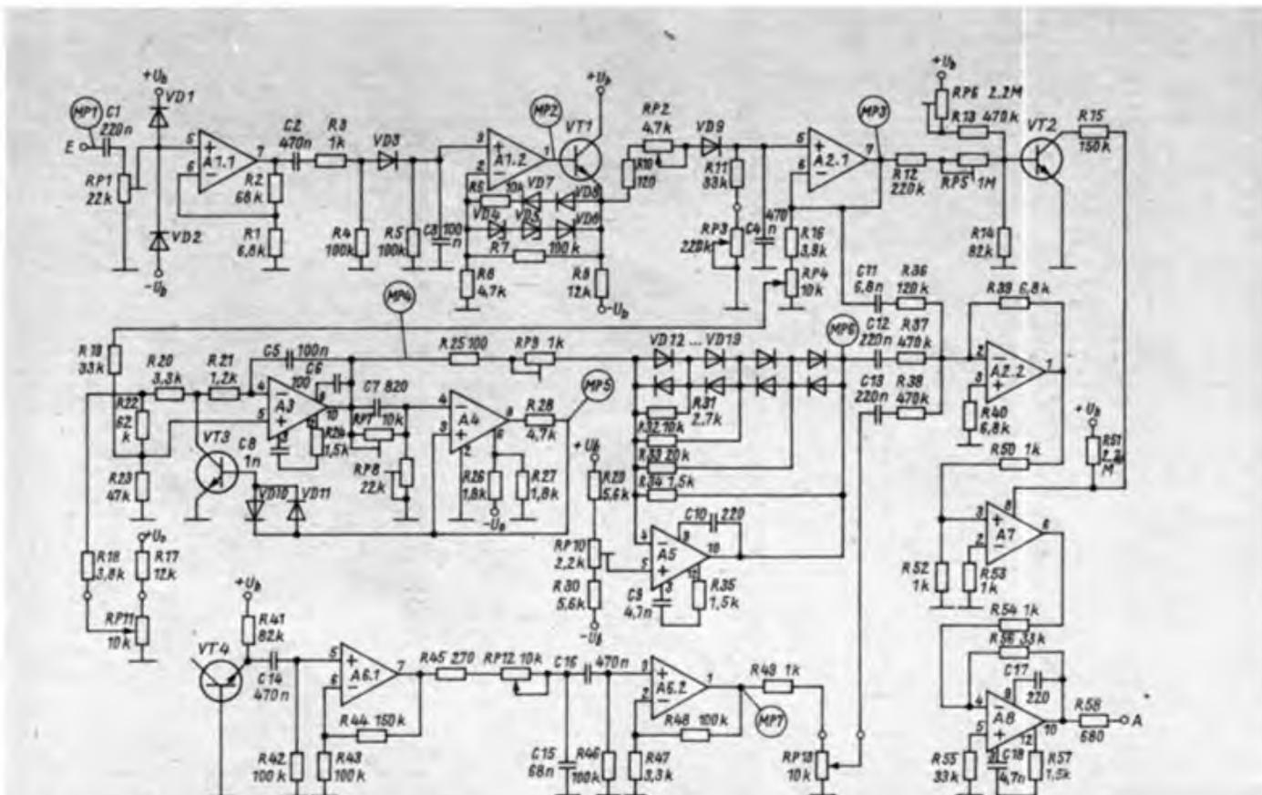
Bild 2: Stromlaufplan des Trommel-Synthesizers
