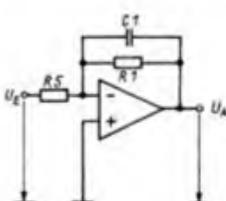
Bild 1: Tiefpaß 1. Ordnung mit kritischer Dämpfung mit Gegenkopplung
