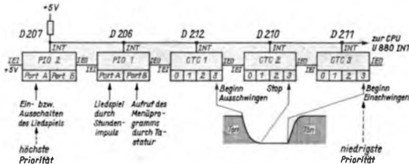
Bild 6: Darstellung der Interruptmöglichkeiten und der Prioritätskette
