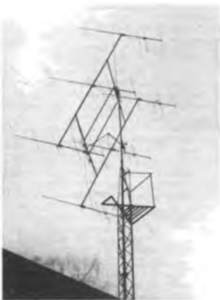
Bild 1: Meine 6x6-Element-Antennengruppe mit G = 18 dB. Der obere Querholm ist nur eingehängt. Der untere kann mit einer Kniehebelskonstruktion vom Mast abgespreizt werden.
