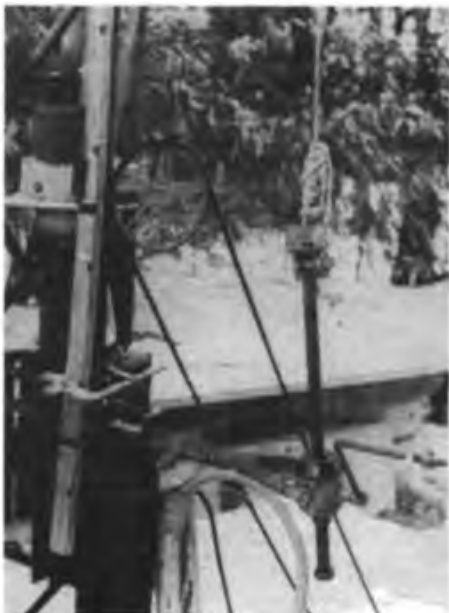
Bild 2: Das Mastfußpanorama. Zur Azimuteinstellung betätigte ich vom Kellershack (Bild 4) aus über eine Welle einen Kettentrieb, der über eine Schnecke das bis zum Boden reichende Mastrohr dreht. Unter dem Schneckentrieb ist ein Drehmaler angeflanscht. Zur Elevations-einstellung kann mit dem Wagenheber ein Zugseil betätigt werden, das am Gelenk des Kniehebels (Bild 1 und 5) befestigt ist. Der Elevationswinkel wird über ein zweites dünnes Seil an der Holzlatte (links im Bild) angezeigt. Unter dem Wagenheber die Kabeleinführung
