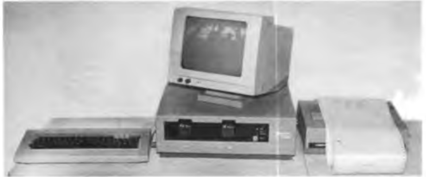
Der 16-bit-Arbeitsplatz-Computer A 7100 verfügt über 10 MByte Speicherkapazität. Einen besonderen Vorteil stellt seine Kompatibilität mit den Betriebssystemen
