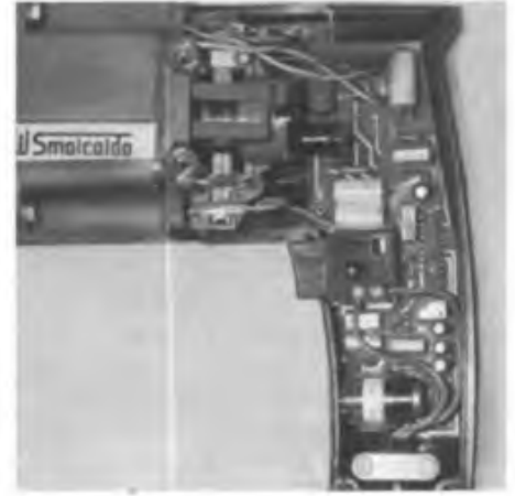
Die Elektronik der neuen Ein- bzw. Zweigangbohrmaschinen HBM 23 bzw. 32 ermöglicht Sanftanlauf, Drehzahlwahl und -konstanthaltung, Leerlaufdrehzahl- und einstellbare Drehmomentbegrenzung, Blockierschutz und Überlastungsschutz
