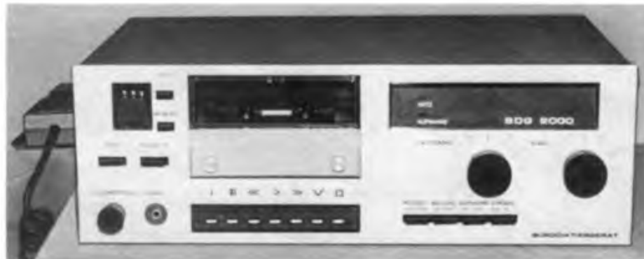
Das mikroprozessorgesteuerte Burodiktiergerät BDG 200 wurde aus einem Standardkassettengerät entwickelt und danach als Frontlader konzipiert. Das BDG 200 läßt sich fernbedienen. Es erlaubt Indexierung, Suchlauf
