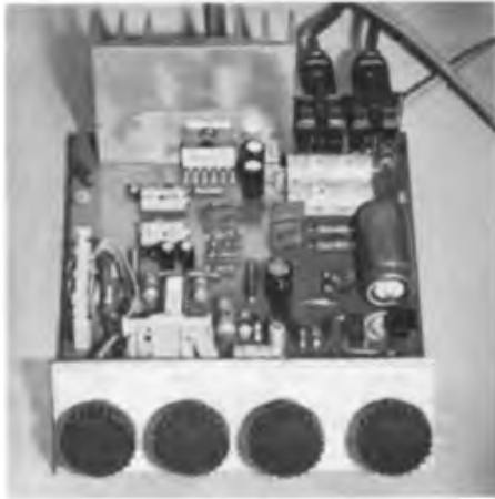
Diese Steller-Baugruppe mit dem gegenüber seinen Vorgängertypen komplexeren Schaltkreis A 1524 D erlaubt die gleichspannungsgesteuerte Variation von Höhen, Tiefen, Balance und Lautstärke.
