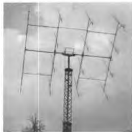
16 14-Element-Langyagis und 2 Stück 4 CX 1000 A als Endröhren im Gegentakt ergeben bei DL8 DAT eine für Europa überdurchschnittliche EME-Anlage.
