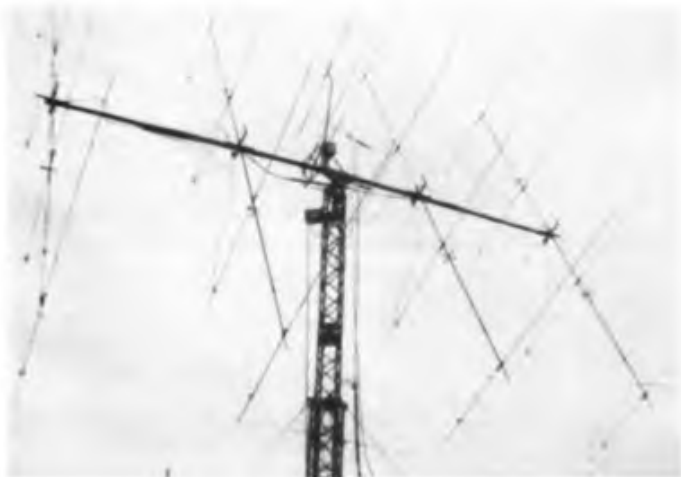
UA1ZCL aus Murmansk benutzt eine Gruppe aus 16 9-Element-Langyagis.
