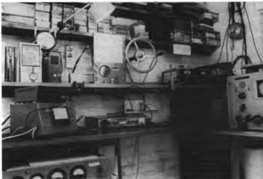
Bild 5: Mein Stationärsch. In der Mitte der Transceiver mit aufgesetzter 10,7-MHz-Nachsetzer-Baugruppe (Bandbreite 110 Hz). Links daneben die mechanische Ablaufsteuerung mit dem Schalterhebel. Darüber ein Frequenzmesser, darunter die Leistungs-Endstufe. Neben dem
