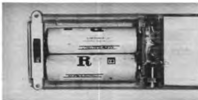
Bild 2: Variante 2. Die Kontaktfedern sind deutlich erkennbar.
