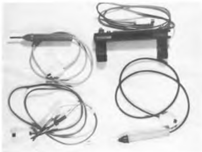
Bild 3: Meßkabel, Testspitzen für 1000 V und ein Shunt für Strommessungen bis 10 A sind mit handelsüblichen VHF-Steckverbindungen aus der Rundfunk/Fernsehtechnik aufgebaut
