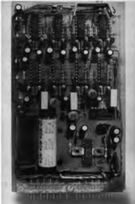
Bild 21: Die Leiterplatte des NF-Verstärkers und der Flip-Flop-Teilerketten
