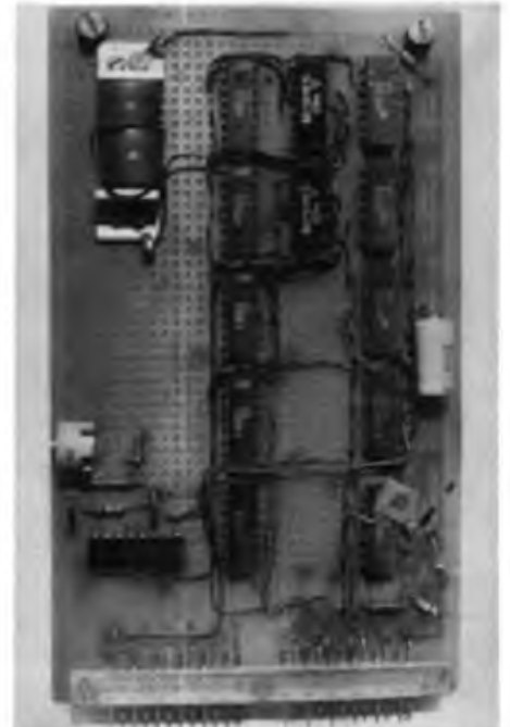
Bild 23: Die Leiterplatte des Uhrmoduls. Links oben die „Notbatterie“
