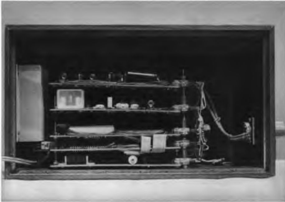
Bild 19: Die Innenansicht des Geräts. Links an der Gehäusewand das Netzteil. Hinter den Leiterplatten ist der Lautspre-
