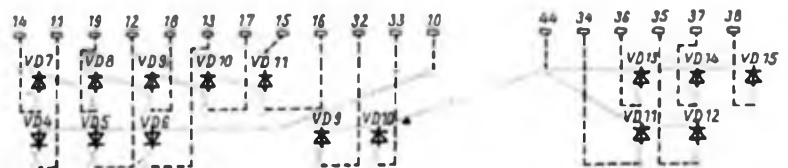
Bild 12: Entwurf der Leitungsführung der Platine C
