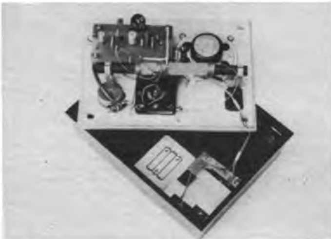
Bild 8: Blick auf das geöffnete Gehäuse des Spielzeug-Radios, erkennbar die Anordnung der Batterie-Stromversorgung
