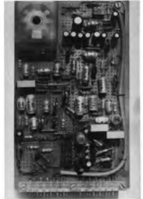
Bild 20: Die Leiterplatte mit Registerschaltung und den Flip-Flop-Teilerketten für die erste Stimme.
