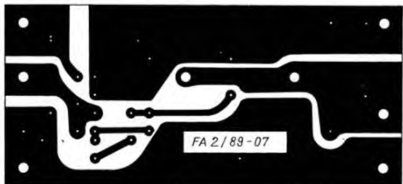
Bild 2: Entwurf der Leitungsführung für die Zündanlage
