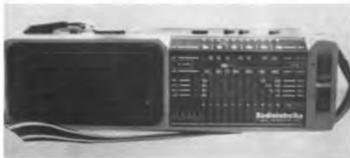
Der Taschenempfänger P5332 (UdSSR) empfängt den CQR-UKW-Bereich, MW und LW sowie die Kurzwellenbereiche von 5,8 bis 12,6 MHz. Er fiel durch ein modernes Design auf.
