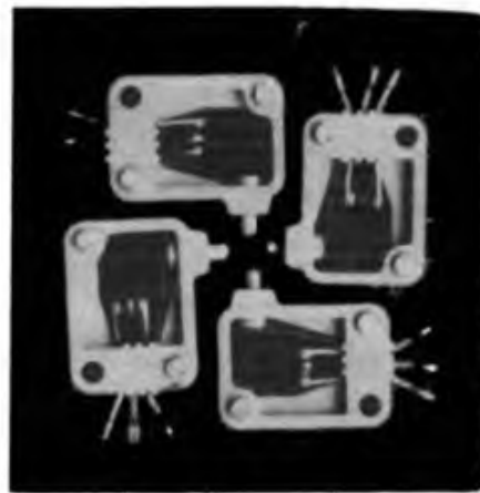
Bild 2: So werden auf der Pertinaxplatte die Mikrotaster angebracht
