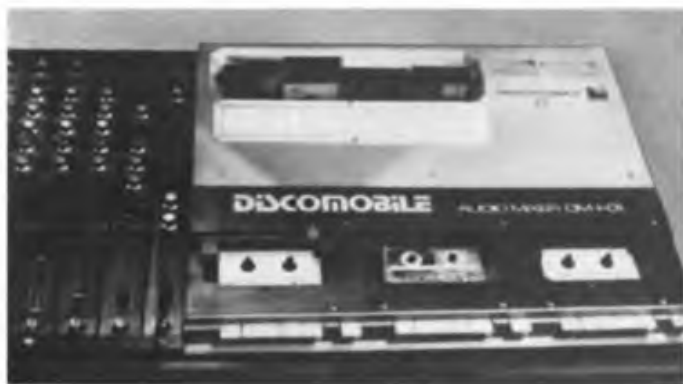
Die Disko-Anlage „im Koffer“ DM 1-01 (UdSSR) enthält drei Kassettenaufwerke und 8 Mixkanäle mit separater Klangregelung sowie ein Stereo-Endverstärkermodule.
