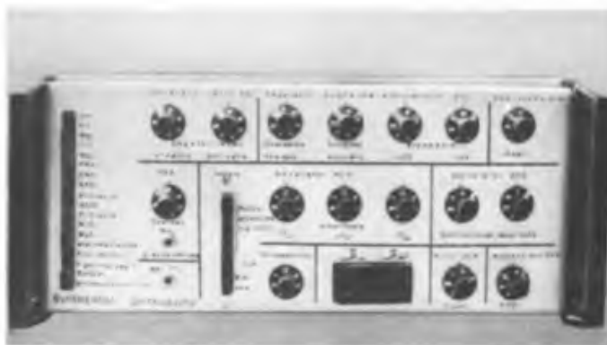
Die Volksrepublik Polen zeigte einen Percussionssynthetizer als Rackeinschub. Mit diesem Gerät ist eine Erzeugung von Percussionsklängen in großer Vielfalt möglich.
