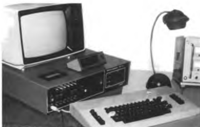
Der Y34ZF-Computer. Er ist mit 64 KByte RAM, einem integrierten Kassettelaufwerk und einem RTTY-Konverter konfiguriert. In einer der nächsten Ausgaben stellen wir diesen Computer ausführlicher vor.
