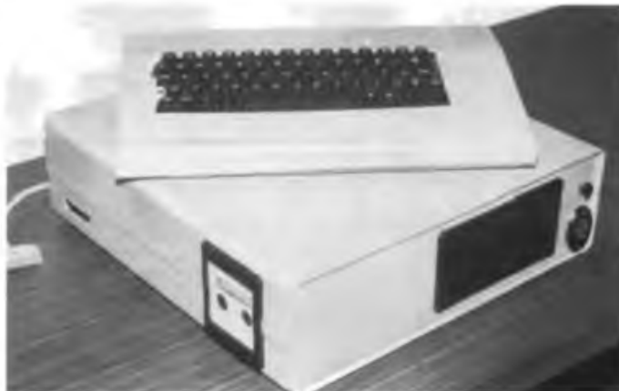
Der AC 1 unseres Lesers Michael Wolter. Er hat ihn mit drei Original-KC-Speichermodule (je 16 KByte) erweitert und plant den Einsatz eines Floppy-Disk-Laufwerkes.
