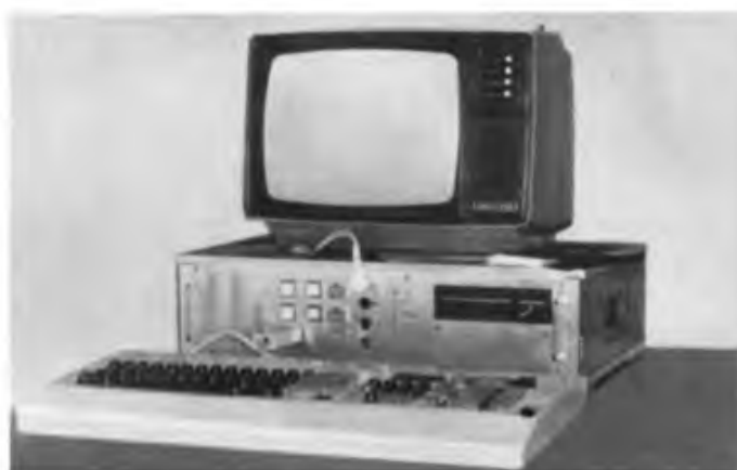
Unser Leser Falko Trull hat seinen AC 1 bereits mit einem 5,25-Zoll-Laufwerk und der 256-K-RAM-Floppy aus MP 3/88 ausgebaut. Mit CP/M ist der Schritt zum Personalcomputer hier bereits getan.
