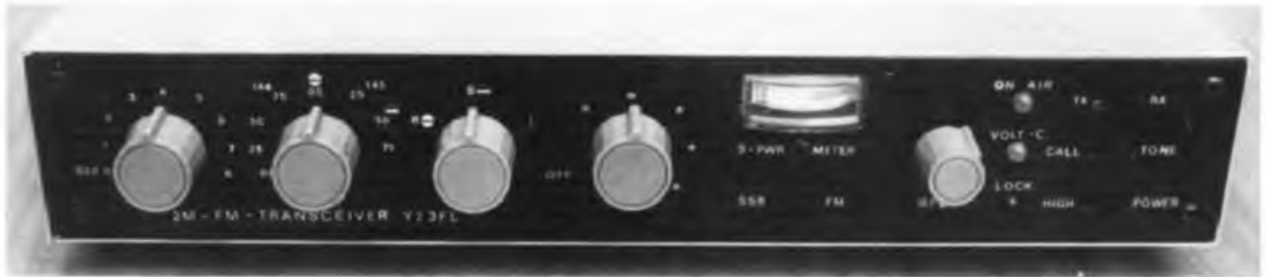
Bild 4: Frontansicht des Transceivers. Links die Bedienelemente des PLL-Oszillators, in der Mitte der Lautstärkesteller und das Instrument zur Felstärke- bzw. Leistungsanzeige, rechts Sende/Empfangs-, Rufton- und Leistungs-Umschalter
