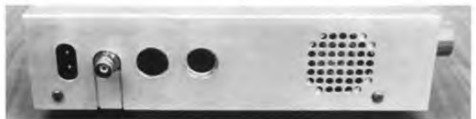
Bild 7: Linke Seitenansicht des betriebsfertigen Geräts. Von links nach rechts: Betriebsspannungs-, Antennen-, Lautsprecher- und Mikrofonbuchse sowie Lautsprecher
