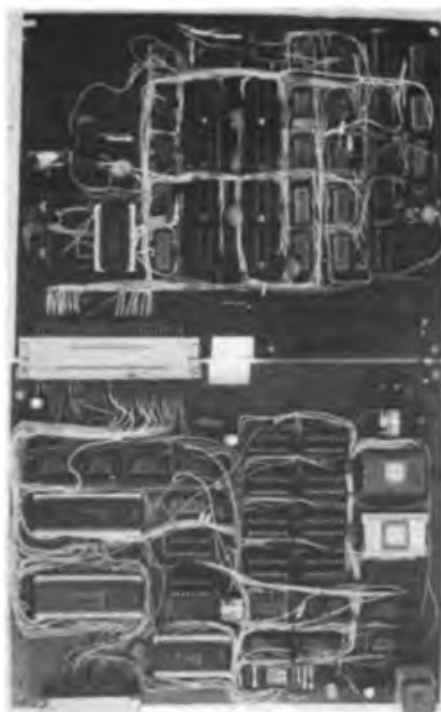
Der noch erhaltene Urahn aller AC 1-Computer, handverdrahtet und auf Lochrasterplatten untergebracht.
