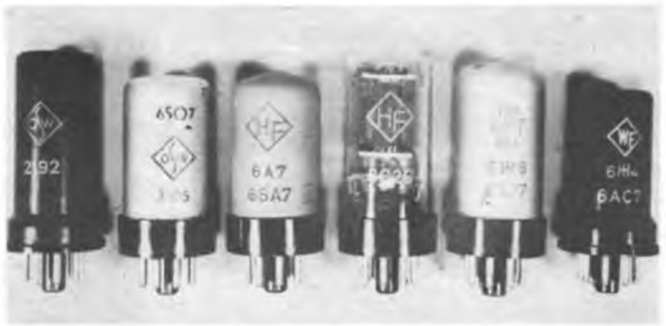
Die Oktalröhrenserie – entwickelt und produziert von 1949 bis 1953
