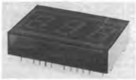
Das neue Anzeigemodul MQE 10 enthält neben einer intelligenten LED-Anzeige bereits den A/D-Wandler und die Anzeigedekodierung
