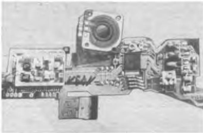
▲ Das elektronische Innenleben der Kleinbildkamera Pentacon BX2 läßt den schon erreichten Stand der SMD-Technologie erkennen
