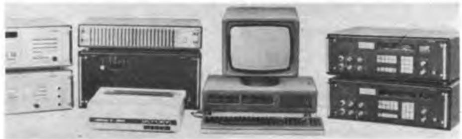
Gehirn des Computer Integrated Radio System genannten neuen Kurzwellen-Kommunikationssystems ist die Steuereinheit KCP 1710, bestehend aus dem Steuerrechner KCP 1711 und dem Bedienrechner PC 1715 W
