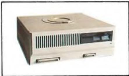
Die Diskettenspeichereinheit enthält ein 1.6-Diskettenlaufwerk, die Steuerung für zwei Diskettenlaufwerke und das Netzgerät für alle Komponenten. In der abgerüsteten (ohne Diskettenspeichereinheit) Version ist das Netzgerät als abgesetzte Einheit ausgeführt.
