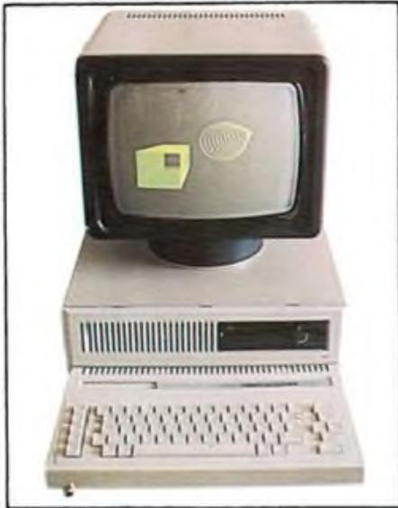
Die komplette Konfiguration des A5105 besteht aus Computergrundgerät, Diskettenspeichereinheit mit Netzgerät und Monitor.
