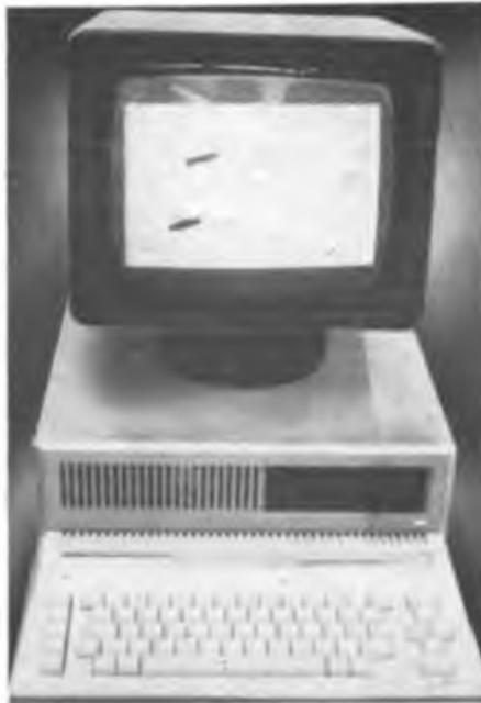
an die Computerarbeit (im Gegensatz zu den bisherigen Kleincomputern) gut erfüllt. Das System ist diskettenorientiert und CP/M-fähig, so kann z. B. PC 1715-Software unter SCP (SCPX) verarbeitet werden. Ein leistungsfähiger BASIC-Interpreter unterstützt das Erlernen dieser Programmiersprache. In das RBASIC wurden auch vom KC-BASIC bekannte Anweisungen implementiert, so daß derjenige, der bereits das KC-BASIC kennt, kaum Schwierigkeiten haben wird, sich einzuarbeiten.
