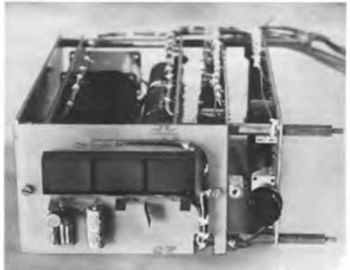
**Bild 21:** Ansicht der Anzeigeleiterplatte, auf der sich auch die Schaltstufe für das negative Vorzeichen befindet. Rechts im Bild Schalter S303 zur Betriebsartenwahl
