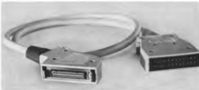
**Bild 24:** Das Verbindungskabel zum Anschluß des A/D-Wandlermoduls an den Steuerrechner
