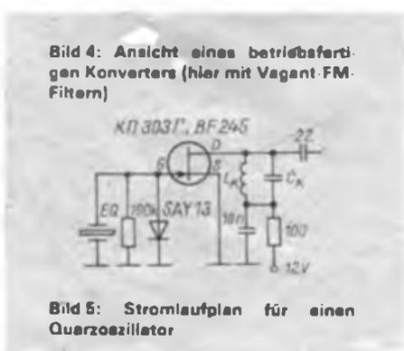
Bild 5: Stromlaufplan für einen Quarzoszillator
