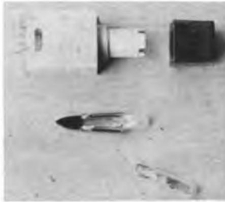
Bild 9: Statt der Glühlampe läßt sich in einen Leuchtdrucktaster auch eine LED einsetzen
