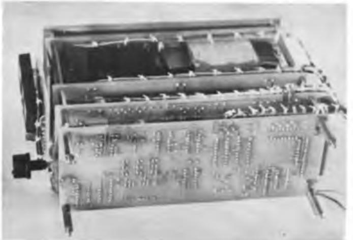
**Bild 23:** Ein seitlicher Blick auf das fertige Modul, bei dem die Leiterbildzeichnung der Leiterplatte Lp301, die die Steuerlogik und das Rechnerinterface enthält, gut erkennbar ist
