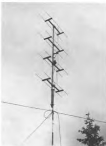
Beim Aufbau ist es wichtig, die einzelnen Rohrstücke fest miteinander zu verschrauben (damit sich die Antenne nicht von selbst drehen kann) und an den Abspannungen stets gut Balance zu halten.
