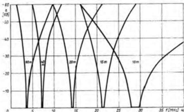
Bild 5: Dämpfungsverlauf der Eingangsbandfilter
