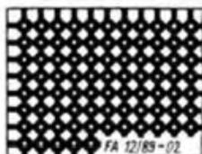
Bild 1: Ausschnitt aus dem Layout der Universalleiterplatte
