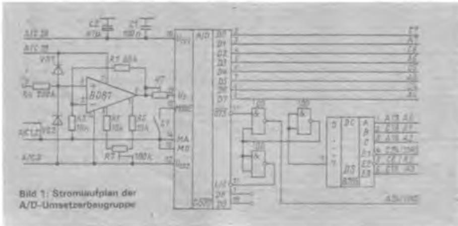
Bild 1: Stromlaufplan der A/D-Umsetzerbaugruppe
