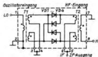
Innenschaltung des UZ 07 und Gehäusegröße mit Anschlußbelegung
