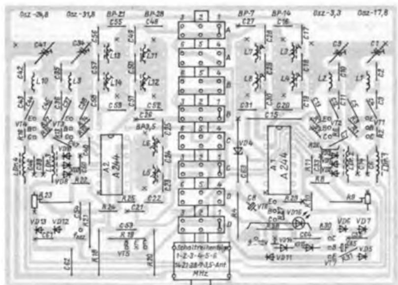
Bild 4: Bestückungsplan der Leiterplatte des KW-Konverters
