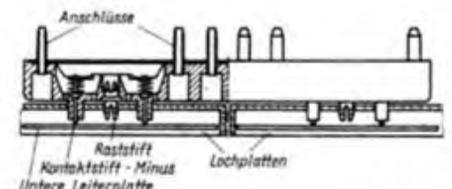
Bild 13: Zur Realisierung größerer Versuchsaufbauten sind mehrere Leiter/Loch-Platten mittels der Kontaktschienen zu verbinden.
