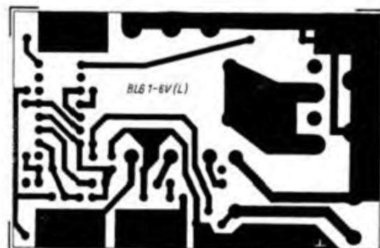
Bild 2: Entwurf des Leiterbildes der Leiterseite
