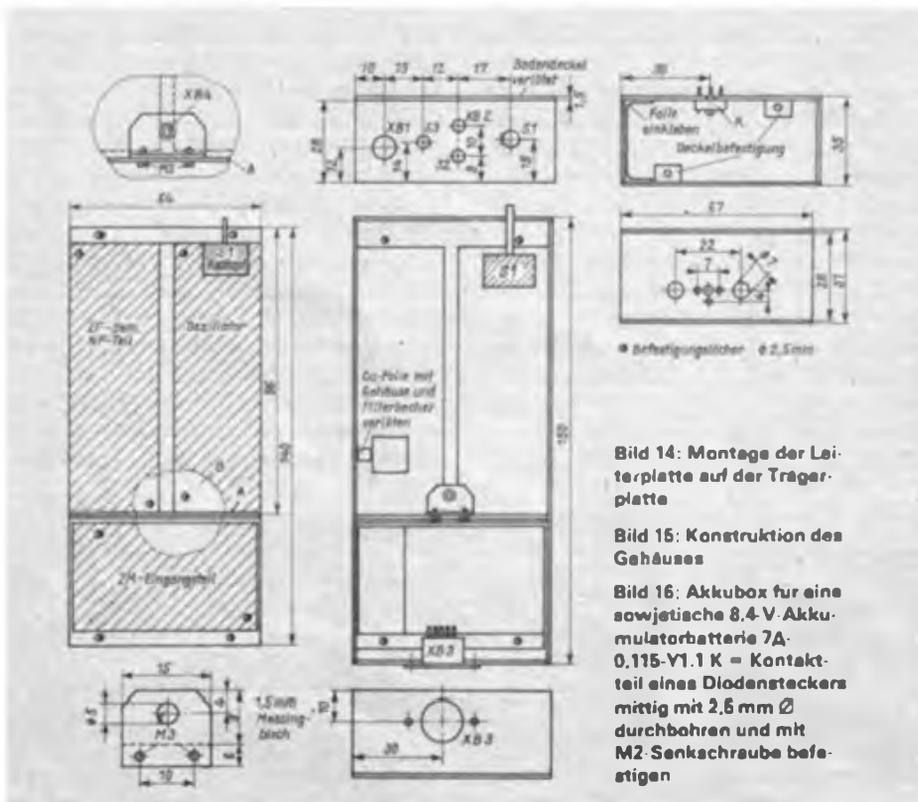
Bild 14: Montage der Leiterplatte auf der Trägerplatte
