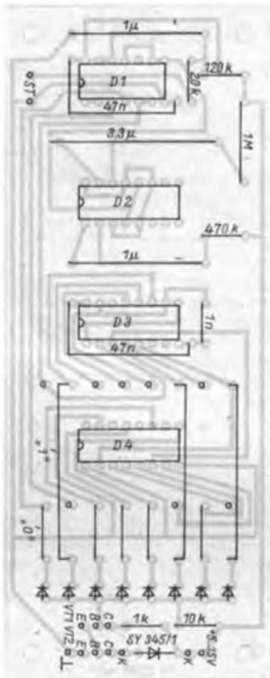
Bild 3: Leitungsführung der Platine des Türschlosses
