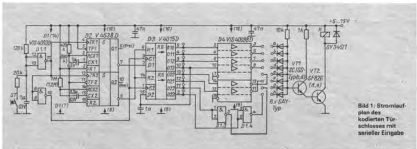
Bild 1: Stromlaufplan des kodierten Türschlosses mit serieller Eingabe
