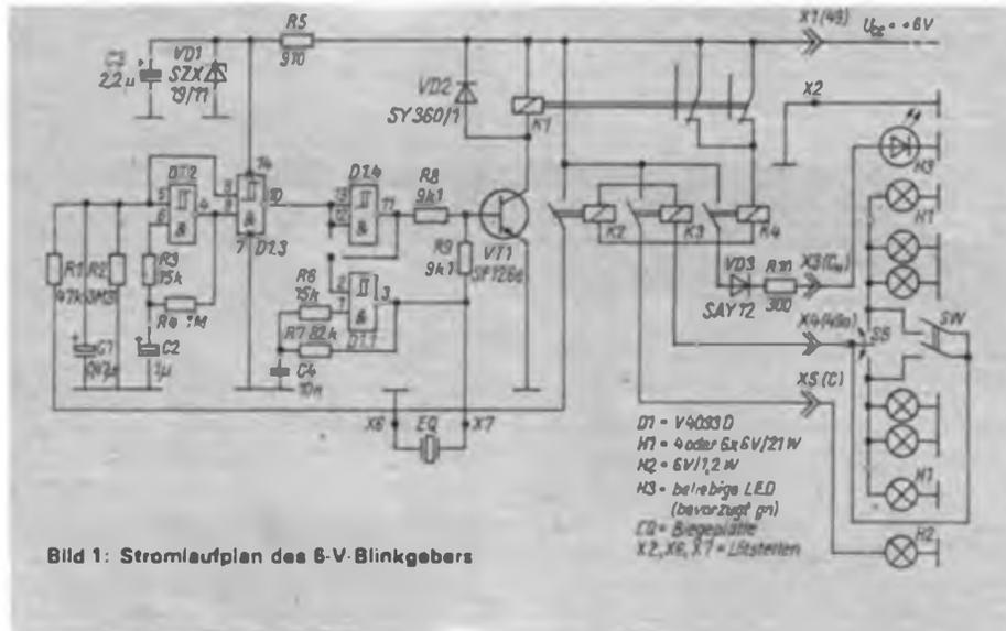
Bild 1: Stromlaufplan des 6-V-Blinkgebers
