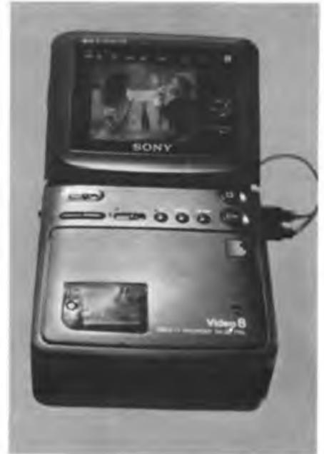
▲ Eine Spitzenleistung der Videotechnik stellte Sony unmittelbar nach der Erstpräsentation auf der IFA '89 auf der LHM in Leipzig aus – den Video-Walkman GV 8, die Kombination eines 8-mm-Video recorders mit einem LCD-Farbfernsehgerät. Der kleine Bildschirm hat eine Auflösung von 92 000 Pixeln bei einer Diagonale von 3 Zoll. In Leipzig wurde diese Innovation mit einer Goldmedaille geehrt.
