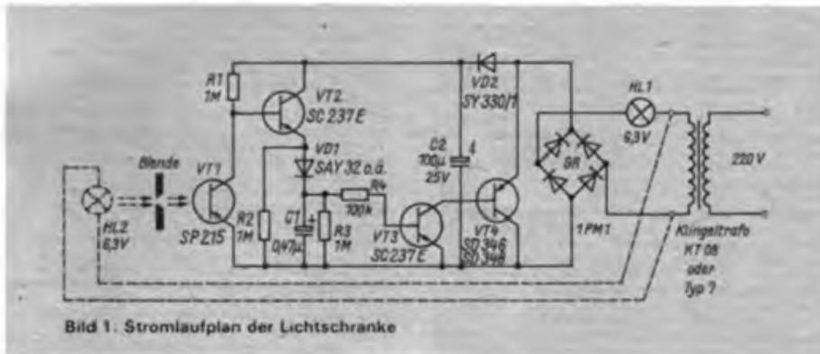
Bild 1. Stromlaufplan der Lichtschranke
