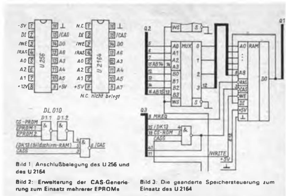
keine Monitorfunktion möglich, so sind alle Adreß- und Datenleitungen einer eingehenden Kontrolle zu unterziehen. Zum Schluß testet man den gesamten RAM-Bereich. Bis ein geeigneter RAM-Test zur Verfügung steht, können dazu die Monitorfunktionen benutzt werden. Eine empfehlenswerte Reihenfolge wäre diese:
