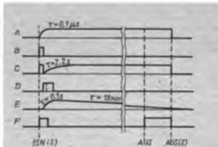
Bild 27 Zur Funktion des automatischen Ausschalters (Zeitkonstanten nicht maßstabgerecht)
