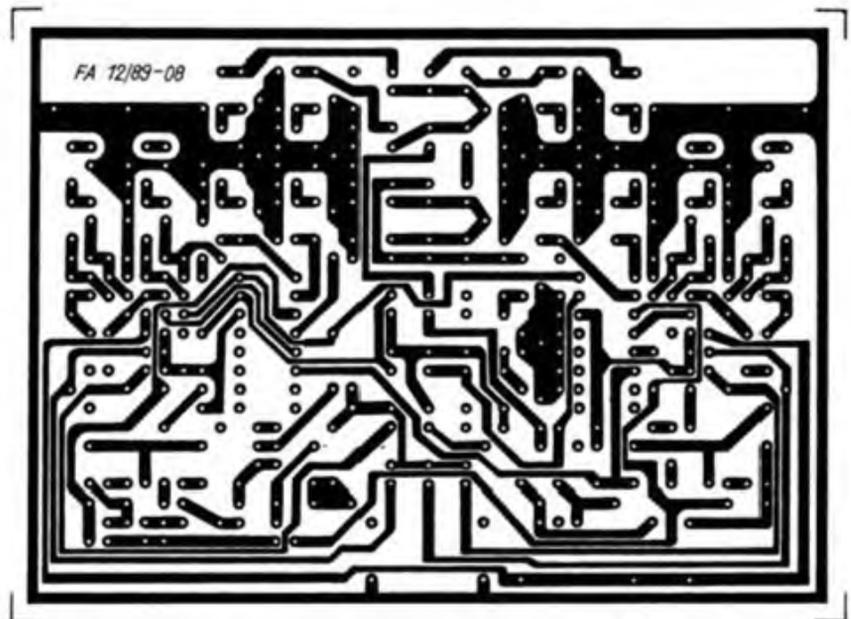
Bild 3: Leitungsführung der (doppelt kaschierten) Platine des KW-Konverters
