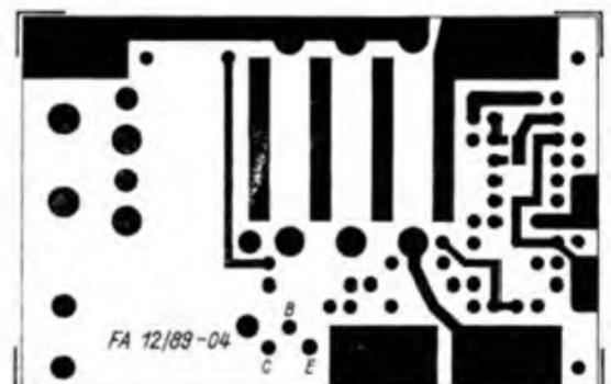
Bild 3: Entwurf der Leitungsführung der Bestückungsseite
