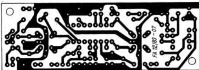
Bild 10: Leitungsführung der Platine für ZF- und NF-Teil
