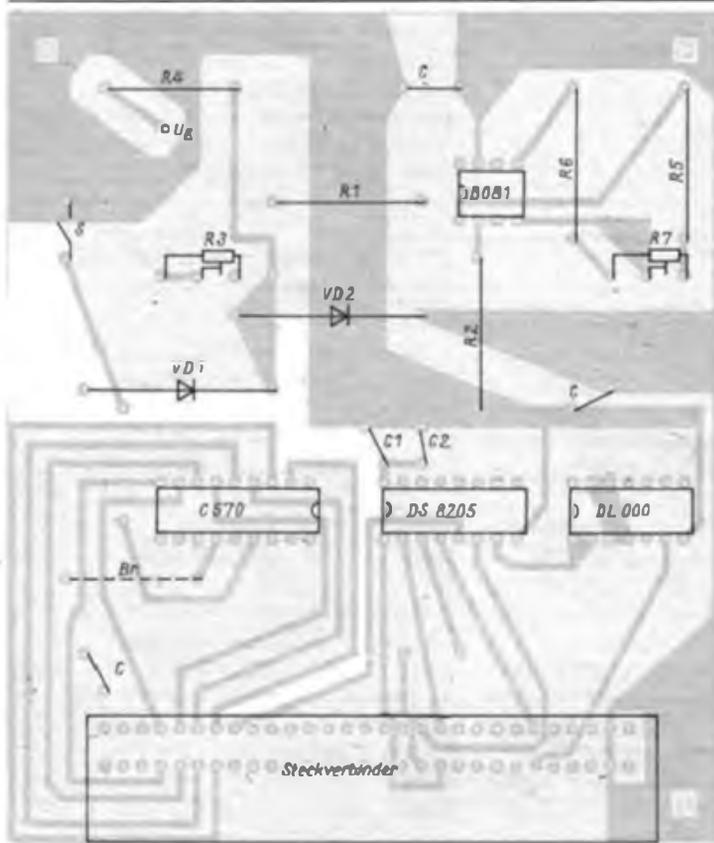
Bild 4: Bestückungsplan der A/D-Umsetzbaugruppe. Die nicht näher bezeichneten Kondensatoren sind 100-nF-Stützkondensatoren
