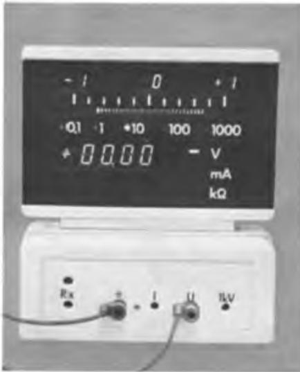
▲ Das Demonstrationsvielfachmeßgerät Quad 01 ermöglicht die digitale und quasianaloge Meßwertdarstellung auf größere Entfernungen, z. B. in Klassenräumen.
