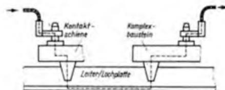
Bild 12: So erfolgt der Stromfluß zu den Bausteinen.
