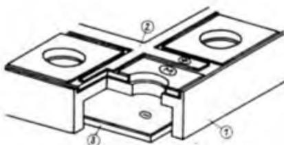
Bild 11: Die Leiter/Loch-Platte ist in drei Ebenen aufgebaut.
