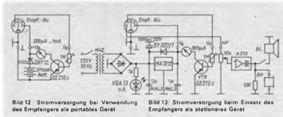
Bild 12: Stromversorgung bei Verwendung des Empfängers als portables Gerät
