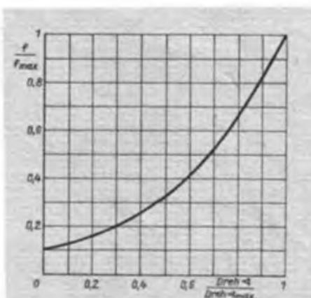
Bild 3: Abhängigkeit der Frequenz vom Drehwinkel, wenn ein Tandempotentiometer  $2 \times 25 \text{ k}\Omega$  lin. mit Parallelwiderständen von  $18 \text{ k}\Omega$  versehen wird
