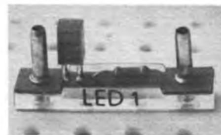
Bild 18: Als Anzeigebau-elemente kommen überwiegend LED zum Einsatz, die paarig antiparallel geschaltet mit dem erforderlichen Vorwiderstand auf dem Bauelementeträger angeordnet sind
