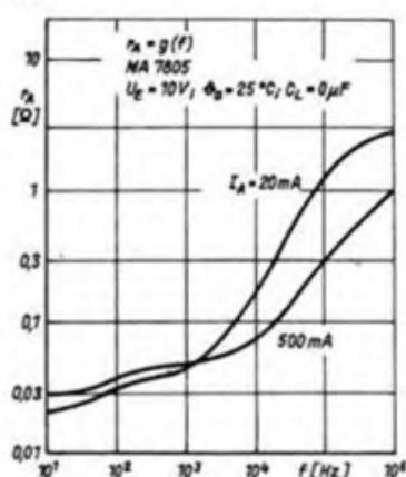
Bild 6: Frequenzabhängigkeit des Ausgangswiderstandes eines MA 7805
