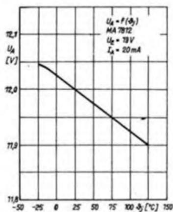
Bild 3: Ausgangsspannung eines MA 7812 als Funktion der Chiptemperatur
