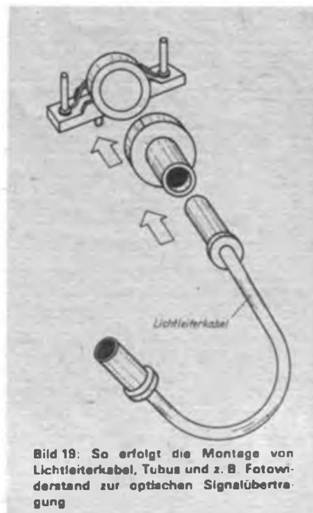
Bild 19: So erfolgt die Montage von Lichtleiterkabel, Tubus und z. B. Fotowiderstand zur optischen Signalübertragung
