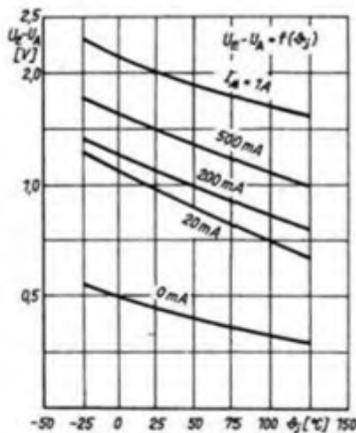
Bild 2: Mindestabfallspannung in Abhängigkeit von der Chiptemperatur
