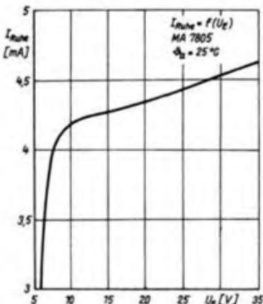
Bild 5: Ruhestrom eines MA 7805 als Funktion der Eingangsspannung
