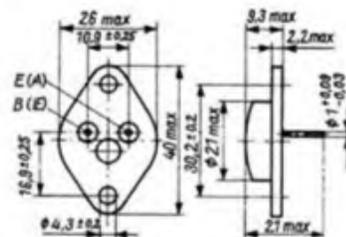
Bild 7: Gehäuseabmaße und Anschlußbelegung der CSSR-Typen (TO3)
