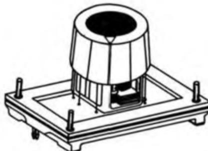
**Bild 21:** Anordnung des Drehkondensators auf dem Bauelementeträger
