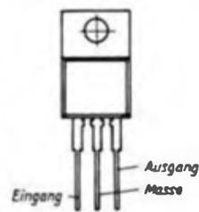
Bild 9: Gehäusevariante im TO-220-Gehäuse (nicht TESLA)
