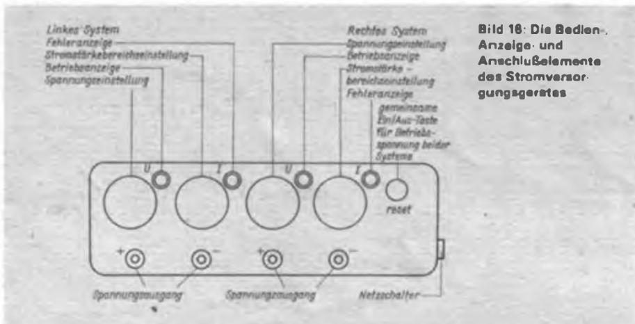
Bild 16: Die Bedien-, Anzeige- und Anschlußelemente des Stromversorgungsgerätes
