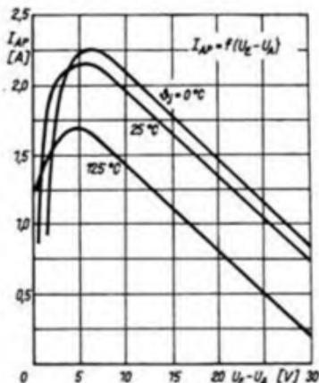
Bild 4: Wirkungsweise der Strombegrenzung bei unterschiedlichen Chiptemperaturen
