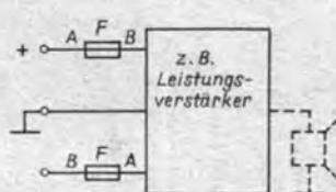
Bild 1: Anordnung der Sicherungsbaugruppe im Wechselstromkreis
