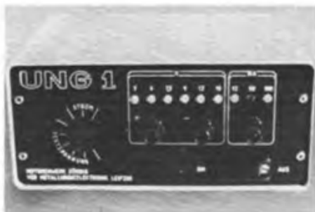
Jetzt gefälliger: Zörbiger Gehäuse im Softline-Design; hier als Universalnetzgerät UNG 1
