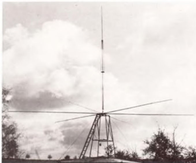
Bild 3: Die betriebsfertige Groundplane-Antenne am erhöhten Standpunkt. Diese Konstruktion hat den Vorteil, daß sie horizontale Radials ohne äußere Abspannpunkte erlaubt. Die „Reuse“ besteht aus Glasfiberstäben und soll lediglich die mechanische Stabilität des Strahlers erhöhen.
