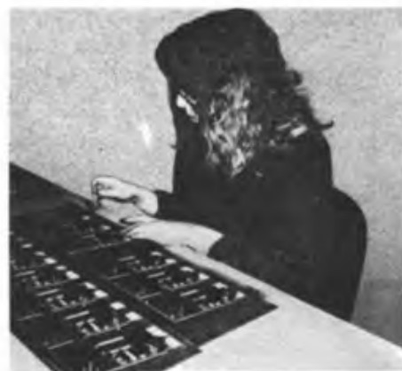
Geschickte Frauenhände sind beim Leiterplattenbestücken gefragt, das aufgrund der relativ kleinen Serien und des permanenten Sortimentwechsels manuell erfolgt
