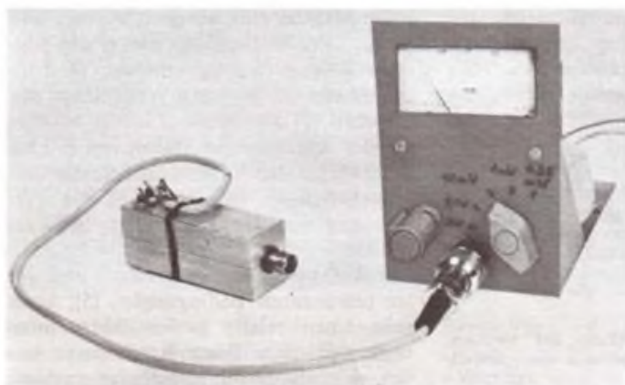
Bild 8: Ansicht eines aufgebauten Bolometers mit Anzeigeeinrichtung
