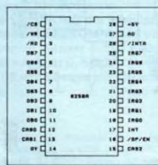
Bild 5: Anschlußbelegung des Interrupt-Controllers 8259
