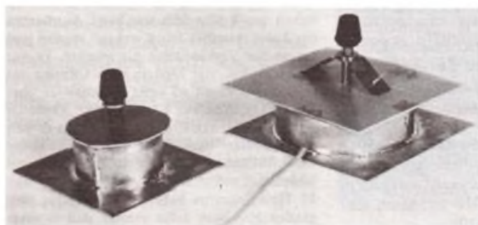
Bild 5: Ansicht zweier aufgebauter Frequenzmesser mit Hohlraumresonator
