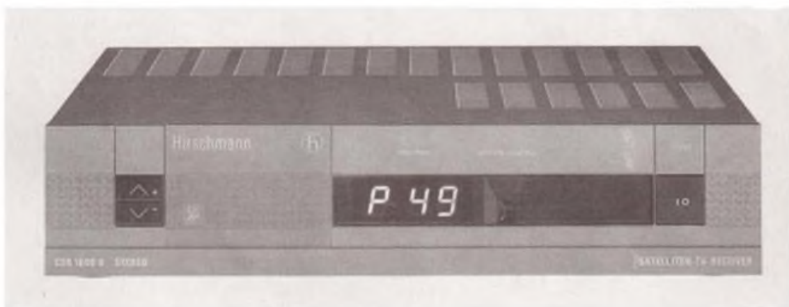
Bild 19: Satelliten-Receiver der Fa. Hirschmann CSR 1600 B Stereo, IR-fernbedienbar, 49 Speicherplätze für Polarizersteuerung, ZF-Bandbreite, Frequenzhub, Tonträgerfrequenz, zwei ZF-Eingänge für 950 bis 1750 MHz, Euro-AV-Anschlüsse für TV-Empfänger und Videorecorder u. v. a. (Werkfoto Hirschmann)
