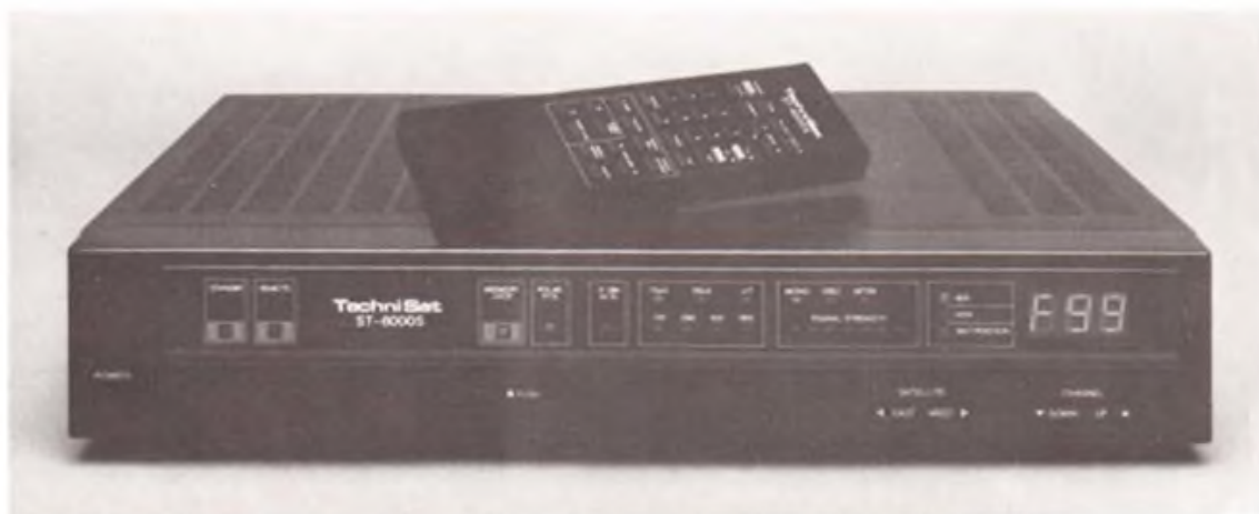
Bild 20: TechniSat-Receiver ST 6000 S, IR-fernbedienbar, Programmierung für 99 Speicherplätze und 29 Satellitenpositionen, Anschlußmöglichkeit für Ferrit- und mechanische Polarizer, Umschaltmöglichkeit für 11- und 12,5-GHz-LNC, 950 bis 1750 MHz Eingangsfrequenz, zwei ZF- und vier Audio-Bandbreiten, S-Meter, Stereo ... (Foto TechniSat)
