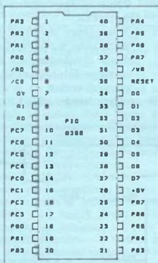
Bild 11: Anschlußbelegung der PIO 8255
