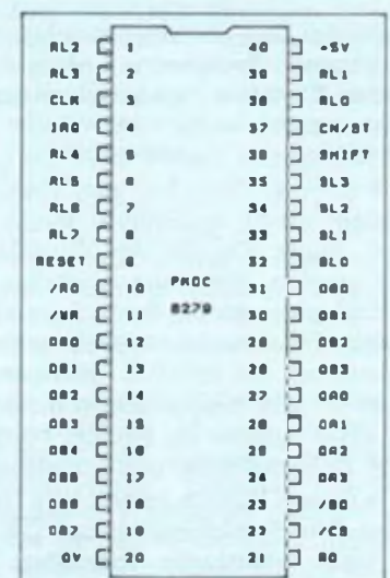
Bild 16: Anschlußbelegung des PKDC 8279
