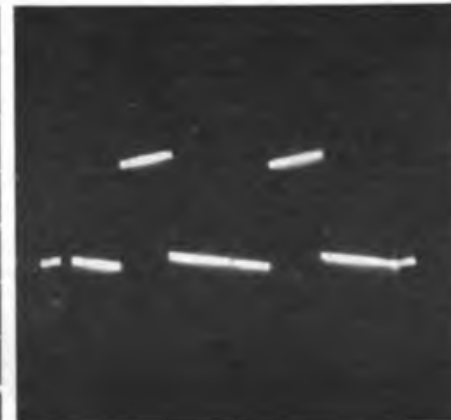
Bild 7: Deutlich ist zu erkennen, daß bei diesem 100-Hz-Signal die Rechteckkurve verfälscht wird
