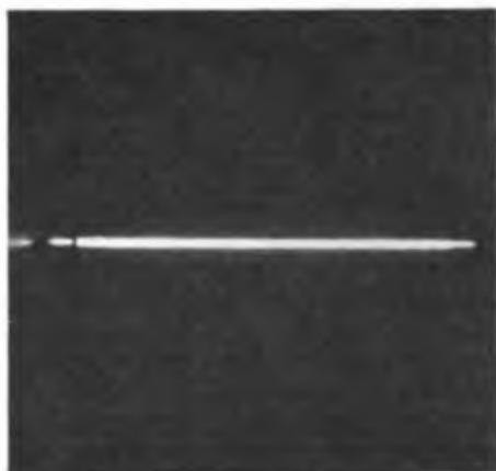
Bild 2: Unscharfer Linienverlauf durch zu großen Strahlstrom (Helligkeit zu stark aufgedreht)
