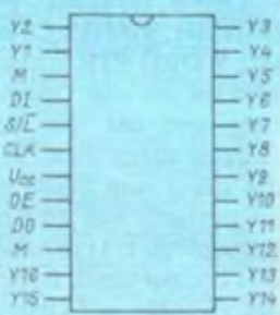
Bild 2: Anschlußbelegung des D 718 D (entspricht UAA 2022)
