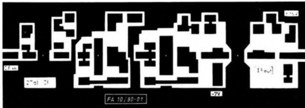
Bild 3: Leitungsführung der Platine im Maßstab 2:1
