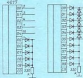
Bild 21: Beliebige entsprechend den Bildern 19 und 20 konfigurierbarer 4017/4050-Zähler
