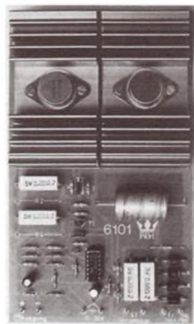
Bild 2: Der aufgebaute Labornetzgeräte-Bausatz in der 5A-Variante. Bei der 2,5 A-Variante kommen kleinere Fingerkühlkörper zum Einsatz.
