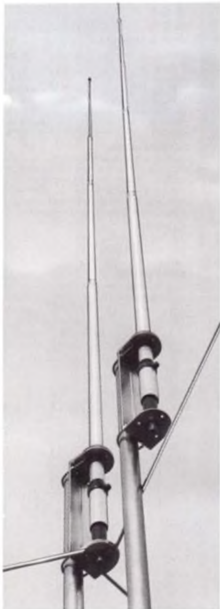
Bild 1: Die vordere der beiden Feststationsantennen ist die Futura 5/8, eine Schwester der bekannten und meistverbreiteten HB 11. Sie besitzt eine Länge von 6,60 m und eine Bandbreite von 1,5 MHz. Ihr Gewinn ist mit 3,5 dB ausgewiesen. Im Gegensatz zur HB 11 läßt sich dieser Typ durch Regulierung des Metallringes am Antennenfuß abstimmen. Das besterreichbare Stehwellenverhältnis wird mit 1,1 angegeben. Dahinter ist die Mercury 1/2 abgebildet, die drei Radials besitzt. Bei einer Länge von 6 m hat sie nur eine Masse von 1,7 kg und eine Bandbreite von 1,7 MHz. Die Windresistenz wird mit 120 km/h und der Gewinn mit 3 dB angegeben. Man kann sie ebenfalls durch Verstellen eines Metallringes am Antennenfuß abstimmen.
