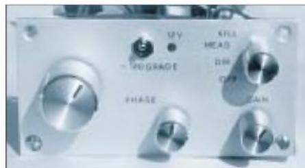
**Bild 15: Frontseite mit Phasenreglern, 180°-Phasenumschalter, Verstärkungsregler und Betriebsmodusumschalter**
