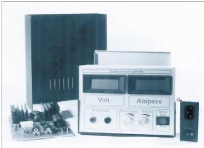
**Bild 33:** Luxus-Netzgerät mit zwei Digitalinstrumenten. Rechts im Bild ein kompletter Netzeingang mit Kaltgerätebuchse, Netzschalter und Sicherungsfach. Frontplatte fertig bedruckt.
