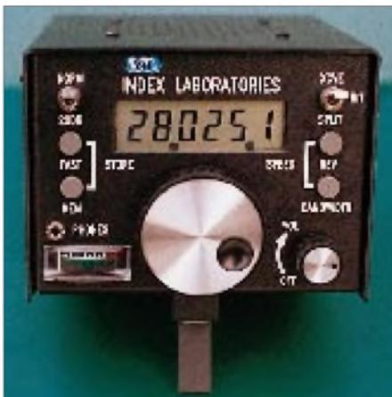
amerikanischen Firma, die normalerweise medizinische Geräte herstellt, und Bruce Franklin, KG7CR, gehört. Der QRP Plus ist ein robustes Gerät von 139 mm × 104 mm × 158 mm Größe und etwa 2,4 kg Masse, das eine Betriebsspannung zwischen 11 und 15 V benötigt. Er begnügt sich bei Empfang mit 120 mA, bei Senden bei CW-Oberstrich je nach Betriebsspannung mit 1,2 bis 2 A, die nach Herstellerempfehlung eine 4-Ah-Gel-Batterie aufbringen können sollte.
