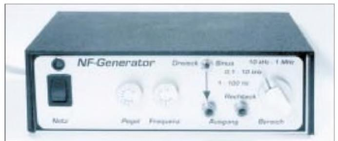
**Bild 34:** Fertig: Der kleine NF-Generator mit edler Alucorex-Frontplatte.
