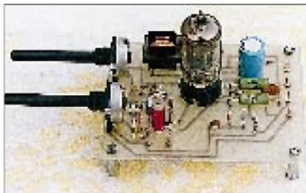
Die gesamte Schaltung paßt auf eine Leiterplatte mit den Abmessungen 100 mm x 75 mm. Je nach Größe der Induktivität ist ein beliebiges Frequenzband im Bereich der Kurzwelle zu empfangen. Beste Empfangsergebnisse erzielt man zwischen 4 und 15 MHz. Der Bausatz kostet inklusive aller Bauteile, der Leiterplatte und einer ausführlichen Beschreibung 59 DM, das Netzteil, Typ 2, 49 DM.
