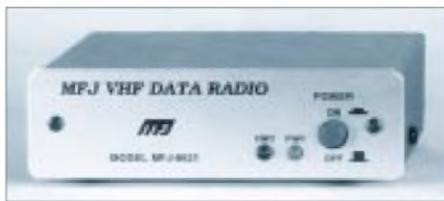
einen durchgehenden 24-Stunden-Betrieb. Der Sender liefert eine für Packet Radio günstige HF-Ausgangsleistung von 5 W und erlaubt somit einen guten Operationsbereich. Die direkte Modulation gewährt eine Datenrate mit 9600 Baud ohne zusätzliche Modifikationen.
