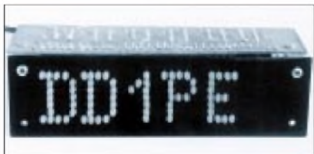
Bild 4: Aufgebaute 90°-Rufzeichenvariante (oben – „Innenaufbau“; unten – Frontansicht)
