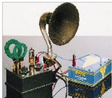
nahme sind ein hochohmiger Kopfhörer (2 kΩ) und eine entsprechende Anodenbatterie AB0194 als Bausatz im Angebot. Die Batterie Typ PERTRIX ist für Anodenspannungen von 90 V (10 Stück Blockbatterien), 70 V und 50 V sowie verschiedene Gitterspannungen (7 Stück Mignonzellen) vorgesehen.
