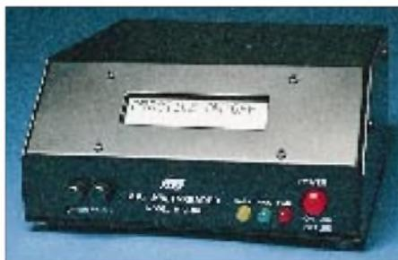
Anschluß und Bedienung des MFJ-462 sind denkbar einfach: Für die Signalverbindung vom Empfänger zum NF-Eingang ist nur ein Kabel notwendig. Die Stromversorgung übernimmt ein 12-V-Steckernetzteil. Die Bedienung ist menügesteuert und erfolgt über zwei Drucktaster und in Englisch. Eine ausführliche deutsche Bedienungsanleitung inklusive Stromlaufplan werden mitgeliefert.
