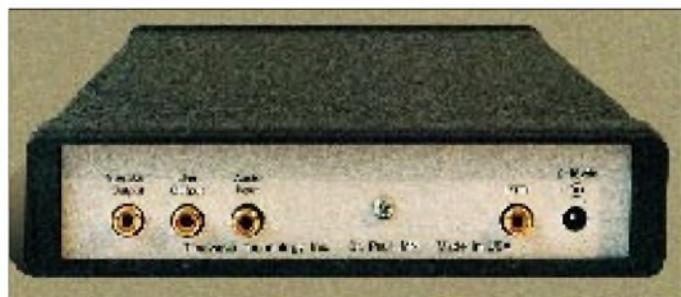
ren und Steckverbinder. Zweitens ermöglicht ein interner NF-Generator (per sinusförmiger Ausgangssignale mit minimalem Rauschen, Pegel durch „Gain“ veränderbar) die Funktionskontrolle der BP/HP/LP-Funktionen; mit einem Zweiton-Testsignal einen Test der SSB-Aufbereitung und mit Mark/Space-Tönen eine Modem-Überprüfung.
