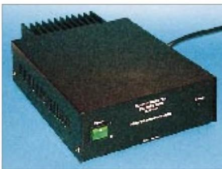
grierter Überspannungsschutz sowie eine Stabilität von etwa 50 mV bei 90 % Last machen dieses Gerät bei günstigem Preis für alle Sendeamateure attraktiv.
