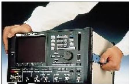
Ein Blick auf den grafisch dargestellten Leistungs/Zeit-Verlauf zeigt sofort, ob das Sendeteil in Ordnung ist. Oder man entscheidet sich für einen der vielen anderen Tests, von der Kontrolle der Frequenz- und Phasenfehler über die Hand-off-Funktion bis hin zur Messung der Empfängerempfindlichkeit (Bitfehlerratenmessung).
