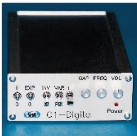
Der Descrambler wird an den NF-Ausgang (Zusatzlautsprecher) gekoppelt. Die Spannungsversorgung übernimmt ein SteckerNetzteil mit 9 bis 12 V Ausgangsspannung und etwa 700 mA Strom.
