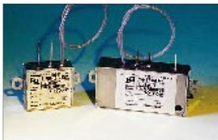
Kurzdaten: TX und RX Allgemeingenehmigung für 433,05 bis 434,79 MHz, TX: 10 mW an 50  $\Omega$ , quarzstabile PLL, Abmessungen 23 mm  $\times$  25 mm  $\times$  9 mm (SMD); Empfänger: Doppelsuperhet, quarzstabile PLL, Datenrate bis 10 kBaud, Abmessungen 48 mm  $\times$  24 mm  $\times$  13 mm.
