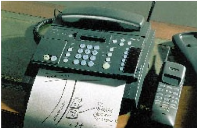
Grundigs Voice-Mailing-System GVM 2000 speichert Sprache auf Festplatte und leitet sie über Netzwerke.
