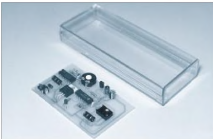
Bild 4: Das Gehäuse kann auf die Platinenmaße gekürzt werden.
