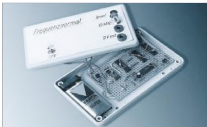
Bild 8: Ansicht des Musteraufbaus des vielseitigen Frequenznormal
