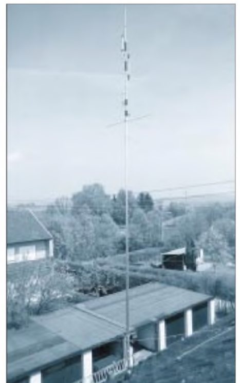
Bild 3: Die erhöht und abgespannt aufgebaute R 5 für die Amateurbänder von 10 m bis 20 m
