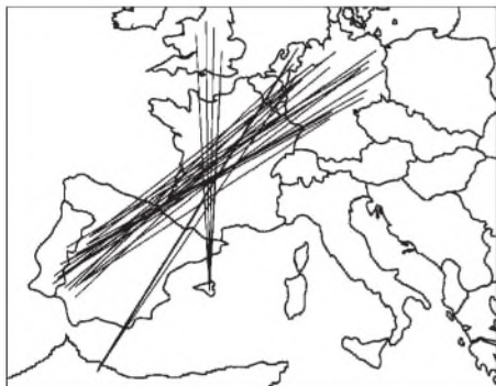
Sporadic-E-Verbindungen am 2.6.95 zwischen 1430 und 1600 UTC auf 144 MHz
