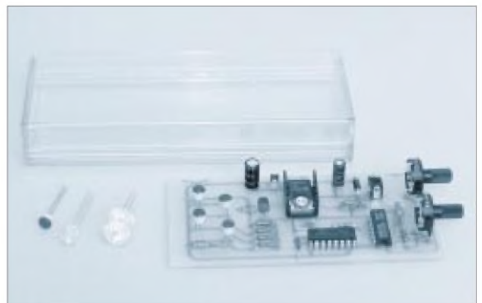
Bild 4: Im Mustergerät wurden Multichip-LEDs eingesetzt
