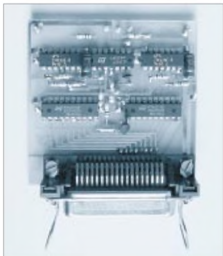
Bild 11: Ansicht des Prototyps der Baugruppe Analog/Digital-Umsetzer
