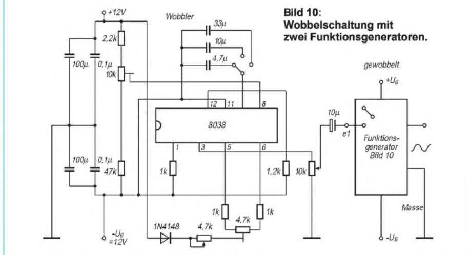
**Bild 10: Wobbelschaltung mit zwei Funktionsgeneratoren.**
