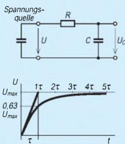
**Bild 2: Aufladen eines Kondensators an einer Spannungsquelle.**
