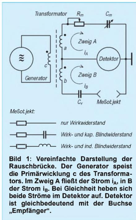
tätswert am Drehkondensator  $C_m$  dem Kapazitätswert von  $C_v$ . In der Praxis bemißt man  $C_v$  mit etwa der Hälfte von  $C_{m\max}$  und bezeichnet diesen Skalenwert unabhängig von seiner Größe als „0“. Bei einem kapazitiven Blindwiderstand liegt nun eine Reihenschaltung zweier Kapazitäten vor, wobei die resultierende immer geringer ist als die kleinste Einzelkapazität.
