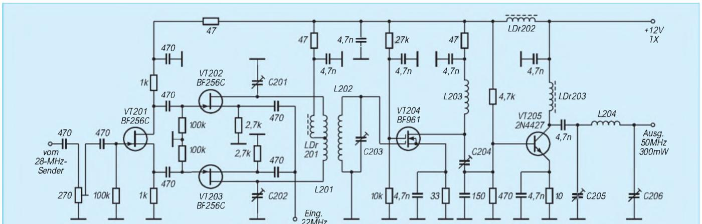
Bild 6: Stromlaufplan des Sendeumsetzers 28 MHz/50 MHz
