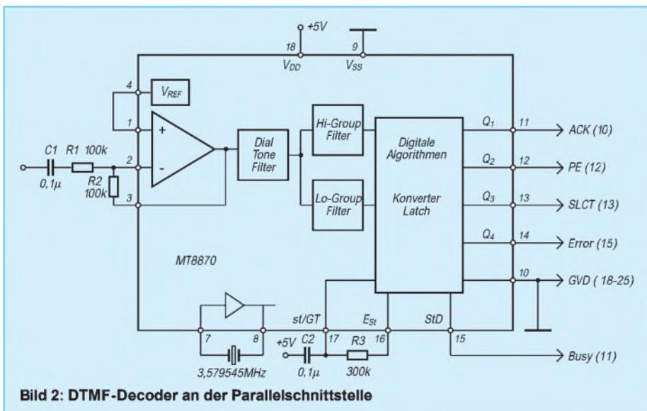
Bild 2: DTMF-Decoder an der Parallelschnittstelle
