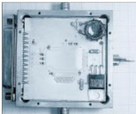
**Bild 7:** Leiterseite des in SMD-Technik realisierten Aufbaus des DDS 1
