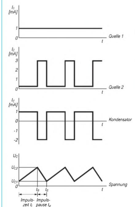
**Bild 8:** Mit dem Erhöhen des Stroms der zweiten Quelle ändert sich das Impuls-Pausen-Verhältnis der Spannungskurve.
