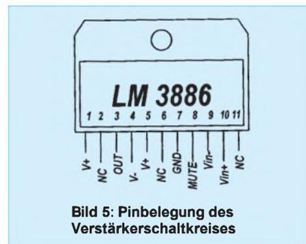
**Bild 5:** Pinbelegung des Verstärkerschaltkreises
