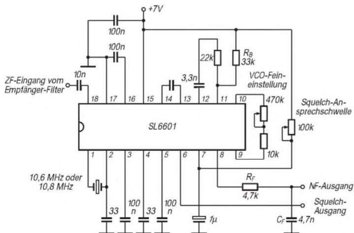
**Bild 8:** Typische Applikationsschaltung ohne Beschaltung des Squelch-Ausgangs Pin 6. Die vom Empfänger-Filter kommende erste ZF hat mit 10,7 MHz einen verbreiteten Wert; im Schaltkreis wird sie auf die zweite ZF von 100 kHz umgesetzt. Ebenso wäre mit einem anderen Quarz ein Wert von z. B. 455 kHz möglich.
