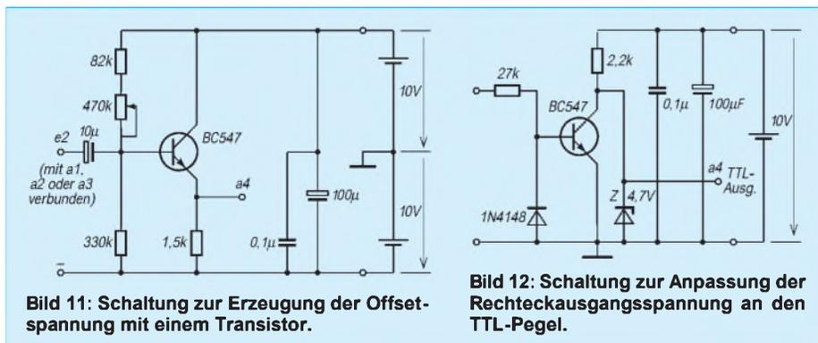
**Bild 11: Schaltung zur Erzeugung der Offsetspannung mit einem Transistor.**
