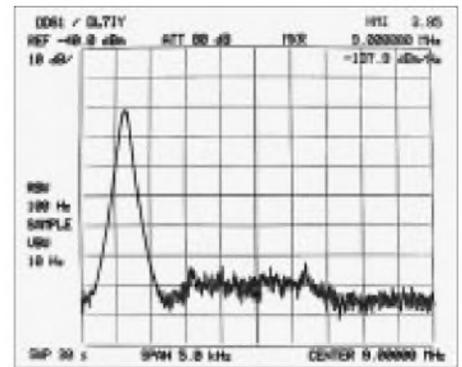
**Bild 9:** Unter Zuhilfenahme eines zehnpoligen Quarzfilters XF 9 S 1 (KVG) gemessenes Rauschseitenband des DDS 1 (vgl. Text)
