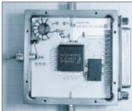
**Bild 6:** Der endgültige, auf in SMD-Technik realisierte Aufbau des DDS 1 (Bestückungsseite)
