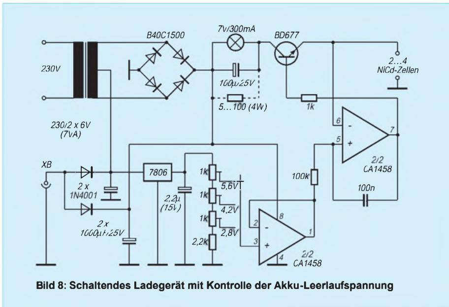
Bild 8: Schaltendes Ladegerät mit Kontrolle der Akku-Leerlaufspannung
