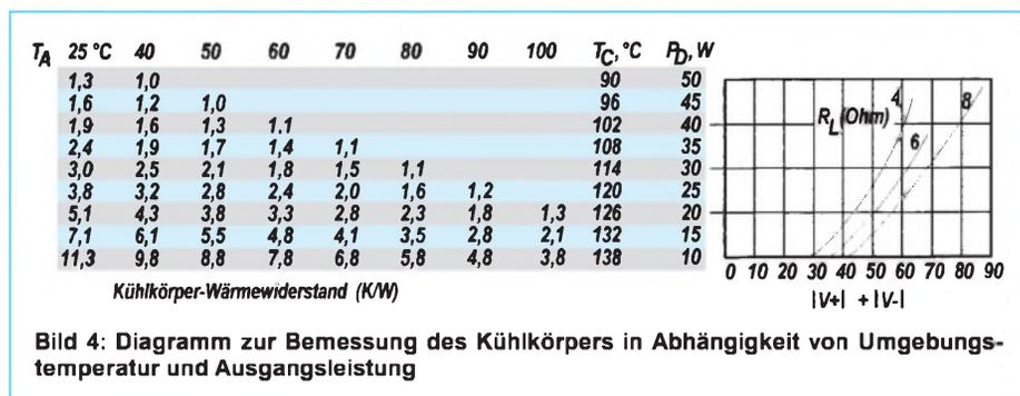
**Bild 4:** Diagramm zur Bemessung des Kühlkörpers in Abhängigkeit von Umgebungstemperatur und Ausgangsleistung
