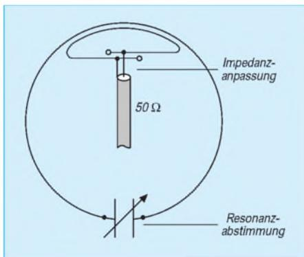
Drehen am Kondensator und der damit verbundenen Kapazitätsänderung kann die Resonanz, also die Betriebsfrequenz verändert werden. Nur eine Antenne, die auf der jeweiligen Betriebsfrequenz in Resonanz ist, kann optimale Ergebnisse liefern.
