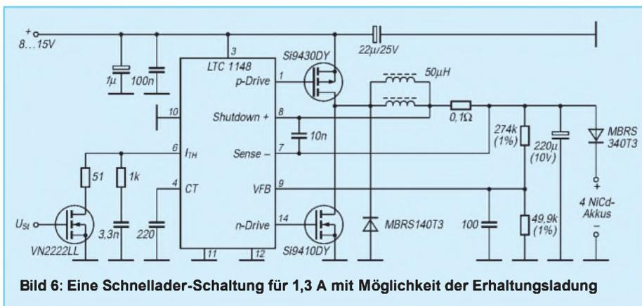
**Bild 6:** Eine Schnelllader-Schaltung für 1,3 A mit Möglichkeit der Erhaltungsladung
