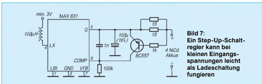
**Bild 7:** Ein Step-Up-Schaltregler kann bei kleinen Eingangsspannungen leicht als Ladeschaltung fungieren
