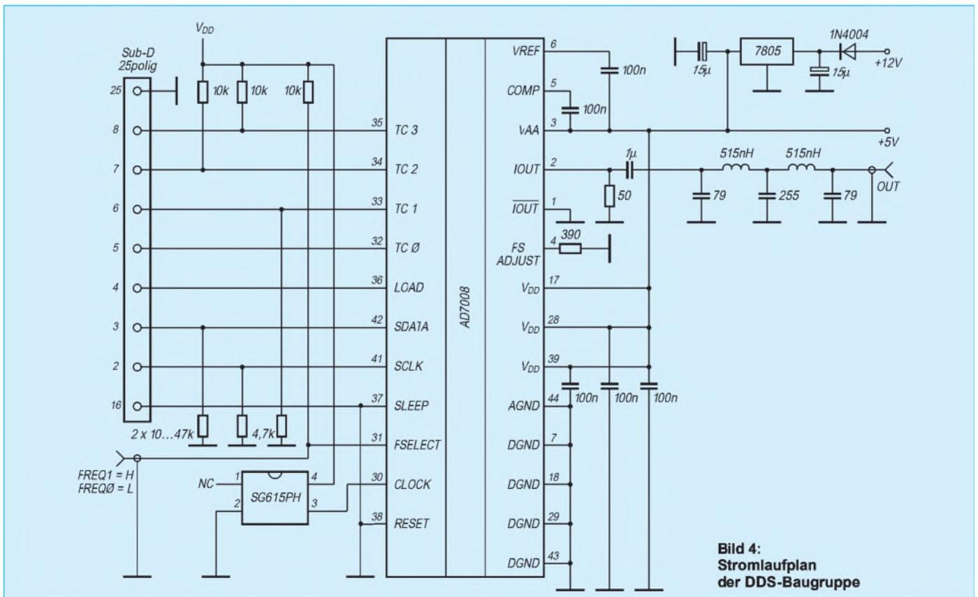
Bild 4: Stromlaufplan der DDS-Baugruppe
