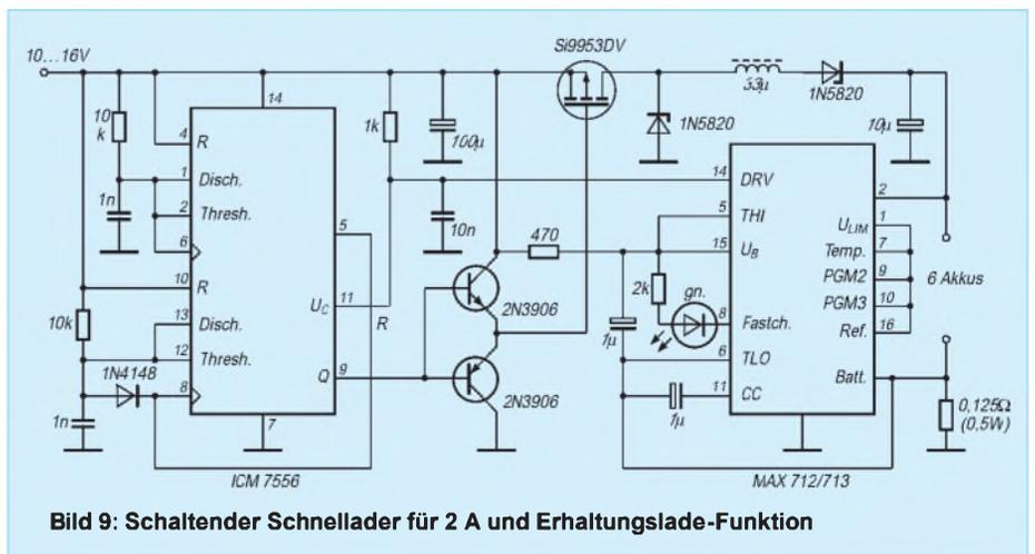
Bild 9: Schaltender Schnellader für 2 A und Erhaltungslade-Funktion
