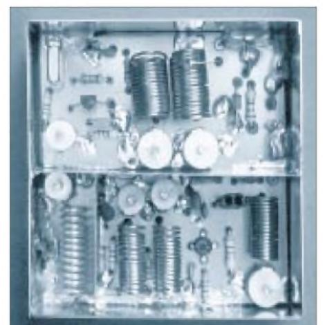
**Bild 5: Eine fertiggestellte Baugruppe Quarzoszillator/Empfangskonverter Foto: Autor**
