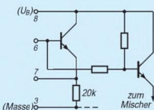
**Bild 1:** Oszillator- und Trennstufen transistor im NE 612
