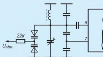
**Bild 4:** Einsatz zweier Kapazitätsdioden
