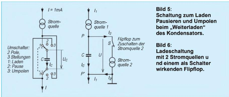
**Bild 5:** Schaltung zum Laden, Pausieren und Umpolen beim „Weiterladen“ des Kondensators.
