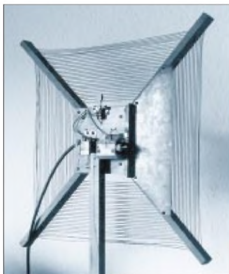
Rahmenantenne für besseren MW-Empfang Fotos: Hans Weber
