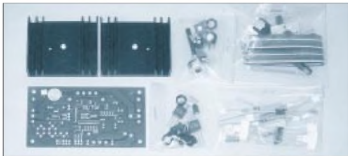
Bild 1: Die Basisplatine ECS 2011 enthält bereits alle SMD-Bauelemente und den fertig programmierten Lade-Chip. Im Bausatz sind alle sonstigen Bauteile enthalten.
