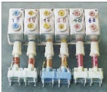
Bild 9: Ein kompletter Spulensatz und drei einzelne geöffnete Bandfilter. Im mittleren sind die Kreiskondensatoren, weil Keramiktypen, oben eingelötet.
