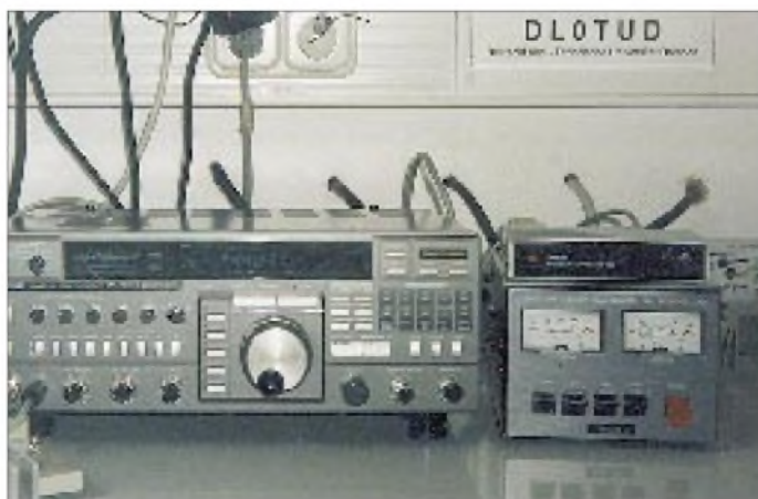
Bild 1: Die KW-Station von DL0TUD. TS-850 mit Computerinterface IF-232 (re. oben) und PTC-Controller (Mitte), links ein 386/SX20 mit Swisslog-Ausbreitungsvorhersage
