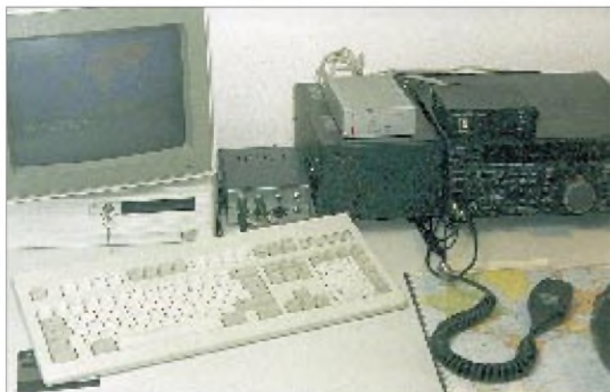
Bild 2: Die UKW-Station von DL0TUD. FT-736 mit Rotorsteuerung KR 5600 und Computerinterface AMSAT IF-100
