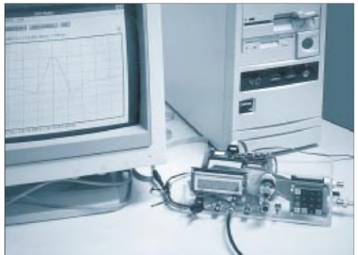
Bild 5: Das aufgebaute Mustergerät erlaubt in Verbindung mit einem PC die komfortable Analyse der Dämpfungseigenschaften von Quarzfiltern.
