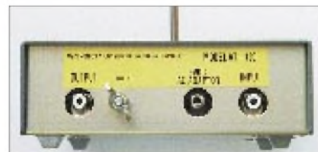
Bild 2: Rückansicht der AT100. Von links nach rechts: Ausgangsbuchse Ausgang (Cinch), Masseschraube, Buchse für externe Stromversorgung (9 V Gleichspannung), Eingangsbuchse (Cinch).
