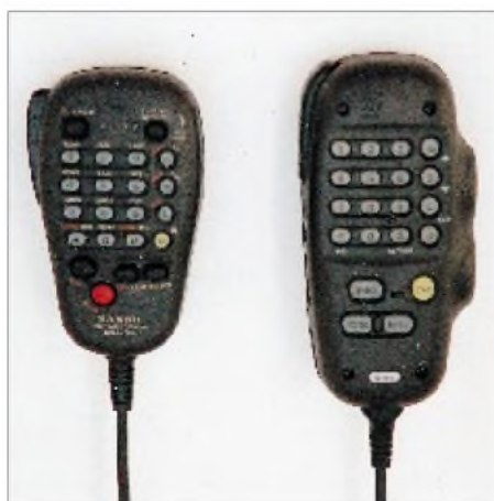
Bild 4: Die Tastenseite der beiden Mikrofone. Links das neue DTMF-Mike MH-39A6J, rechts der Smart Controller
