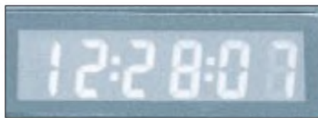
Das Display zeigt nicht nur die Frequenz auf 100 Hz genau an, sondern auf Wunsch auch die sekundengenaue Uhrzeit. Darüber hinaus stehen zwei Timer für automatisierten Empfangsbetrieb zur Verfügung.
