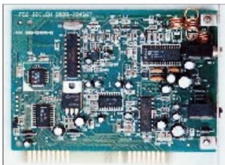
Mehrere Discounter haben jetzt äußerst preiswerte PC-Karten im Angebot, mit denen man neben der Arbeit am Rechner UKW-Rundfunk hören kann. Zur Karte gehört eine entsprechende Software zur Steuerung mit Timer- und Scanfunktion.
