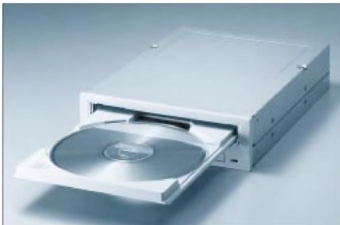
**TEACs 6-fach-CD-ROM-Drive CD-56E bricht mit einer Zugriffszeit von 135 ms und einer Übertragungsrates von 900 kB alle Geschwindigkeitsrekorde**
