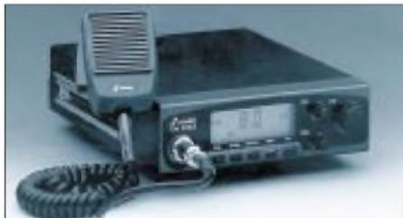
Mit 80 FM-Kanälen mobil ist man mit dem stabo xm 4082, ein übersichtliches neues AM/FM-CB-Funkgerät der stabo Elektronik GmbH. Für dieses Gerät ist die BZT-Zulassung als CB-Mobilstation und als CB-Feststation beantragt. Ausgestattet ist das xm 4082 mit den praktischen Details, über die bereits das 40-Kanal-Gerät xm 4042 verfügte.
