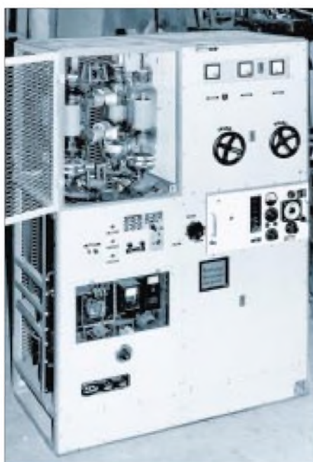
Bild 12: Gesamtansicht des 3-kW-Störsenders Fotos: J. Kullmann
