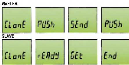
Bild 3: Sehr praktisch – aber nur selten anwendbar: Clonen über Verbindungskabel
