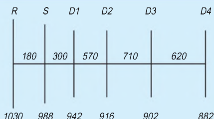
Bild 2: Abmessungen der 6-Element-Yagi (Typ 3)
