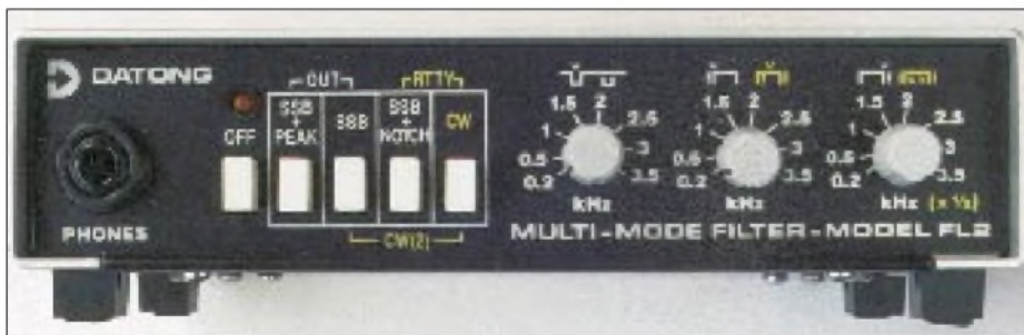
Bild 1: Frontansicht des FL2. V.l.n.r. Klinkenbuchse für Kopfhörer, die fünf Schiebeschalter, Steller für Peak/Notch, in der Mitte Steller für untere Flanke bzw. Mittenfrequenz bei CW/RTTY, rechts Steller für obere Flanke bzw. Bandbreite bei CW/RTTY
