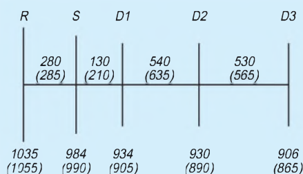
Bild 1: Maße der 5-Element-Yagi (Klammernwerte: Typ 2)
