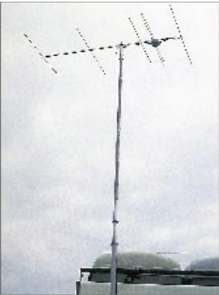
Bild 4: 5-Element-Kurzyagi (Typ 1) mit Faltdipol als Strahler
