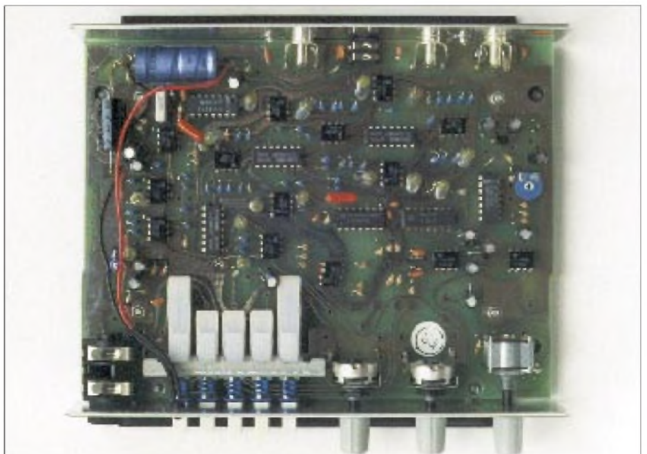
Bild 1: Frontansicht des FL2. V.l.n.r. Klinkenbuchse für Kopfhörer, die fünf Schiebeschalter, Steller für Peak/Notch, in der Mitte Steller für untere Flanke bzw. Mittenfrequenz bei CW/RTTY, rechts Steller für obere Flanke bzw. Bandbreite bei CW/RTTY
