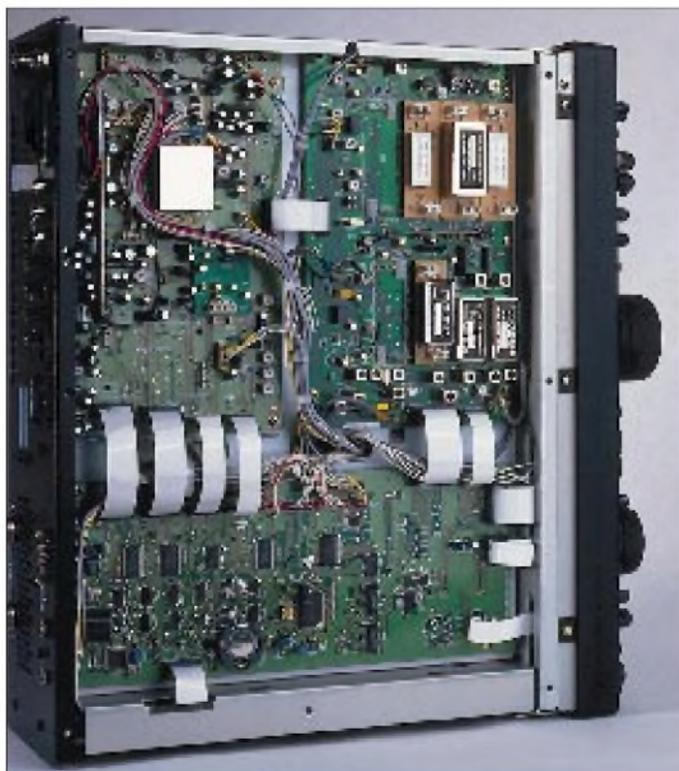
**Bild 3:** Die Innenansicht der Unterseite des FT-1000MP zeigt drei Haupt-Leiterplatten, auf die „huckepack“ weitere aufgesteckt sind. Es ist Platz für allerlei nachrüstbare Filter für beide Zwischenfrequenzen, 8,215 MHz und 455 kHz, vorhanden. Das 500-Hz-Zusatzfilter für den Zweitempfänger ist hier bereits eingebaut.
