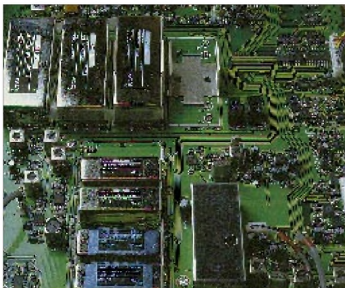
Bild 3: Bei abgenommenem Gehäusedeckel zeigt sich ein mustergültiger Aufbau in jeweils voneinander abgeschirmten Modulen. Auch im Zeitalter der DSP-Technik verzichtet Icom nicht auf allerhand Möglichkeiten für Quarzfilter.
